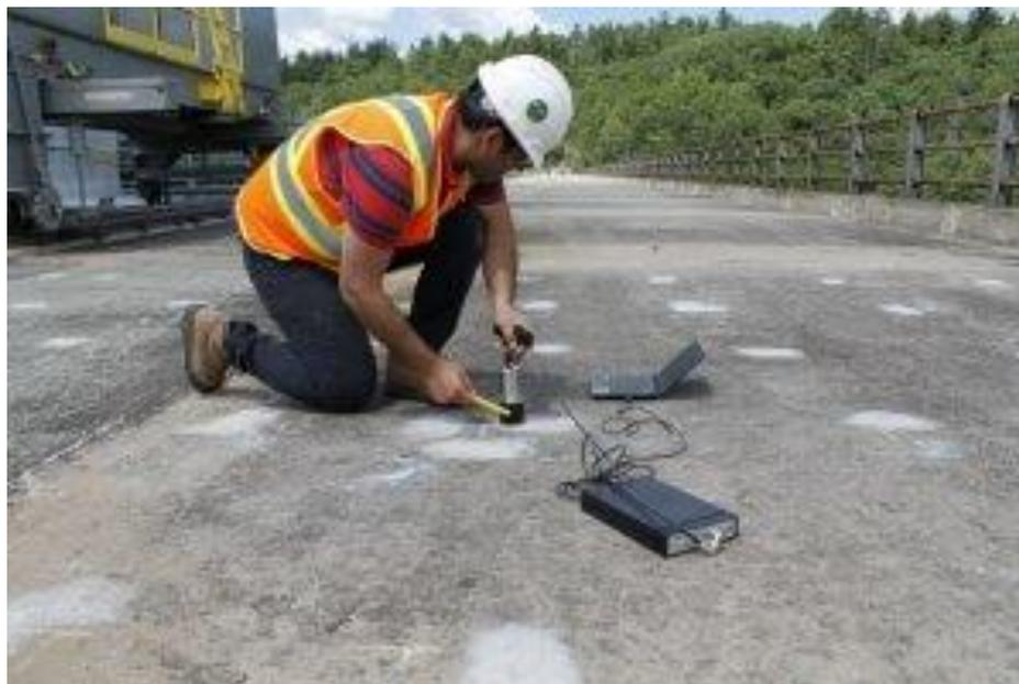
*Figura 6-2 Ensayo Eco de Impacto (FprimeC, 2017)*
