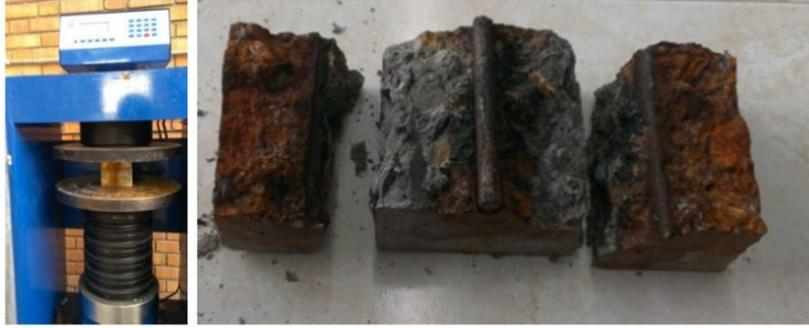
Figura 8-7 Ensayo de compresión sobre probeta y resultados (Shayanfar et al., 2016)
