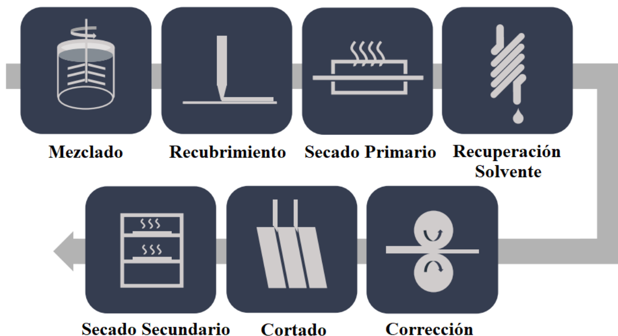
Figura 6.9: Esquema de una planta de fabricación de electrodos [91].
