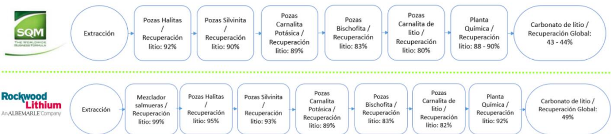
Figura 2.4: Esquema simplificado de recuperación del proceso de SQM y RLL [11].
