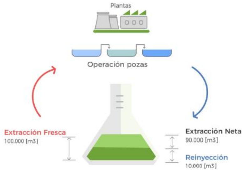
Figura 2.7: Extracción fresca, neta y reinyección de salmueras por SQM [20].
