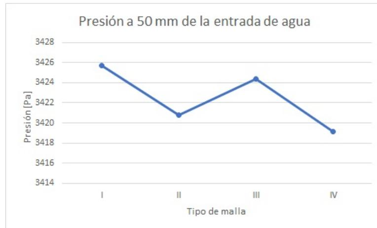
Figura 7.9: Prueba de malla modelo 2D completo: Presión a 50 mm de la entrada de agua.
