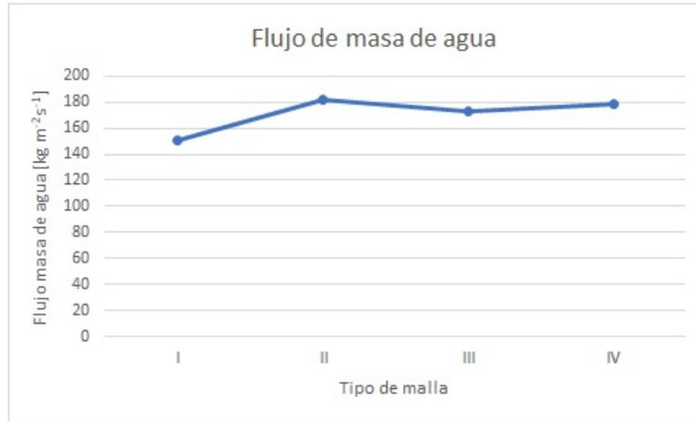
Figura 7.10: Prueba de malla modelo 2D completo: Flujo de masa de agua a la salida.
