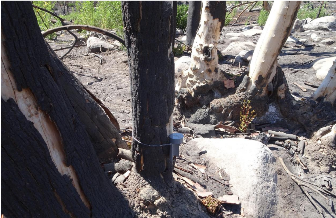
Figura 4: Imagen referencial de la metodología de campo para la obtención de datos microclimáticos. Caseta con el sensor instalado a 10 cm del suelo, calibrados para medir la temperatura del aire.
