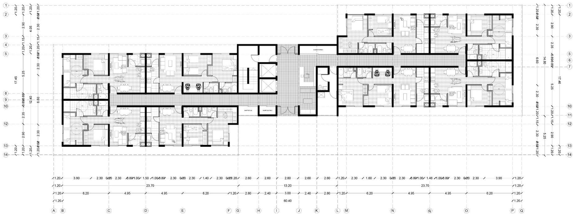
Figura 6: Planta 1° edificio 6 pisos, escala 1/200. Fuente: Elaboración propia.
