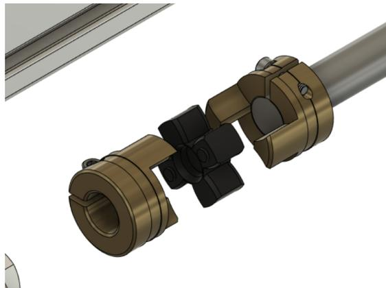
Figura 5.27: Conector de ejes elástico.
