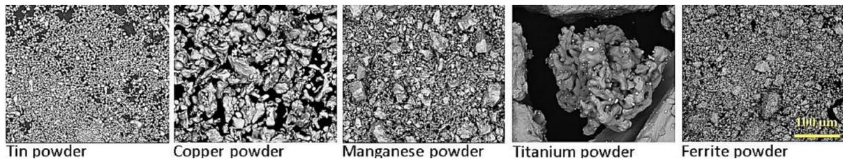
Figura 2.6: Morfología de polvos metálicos obtenida por microscopía electrónica [5].
