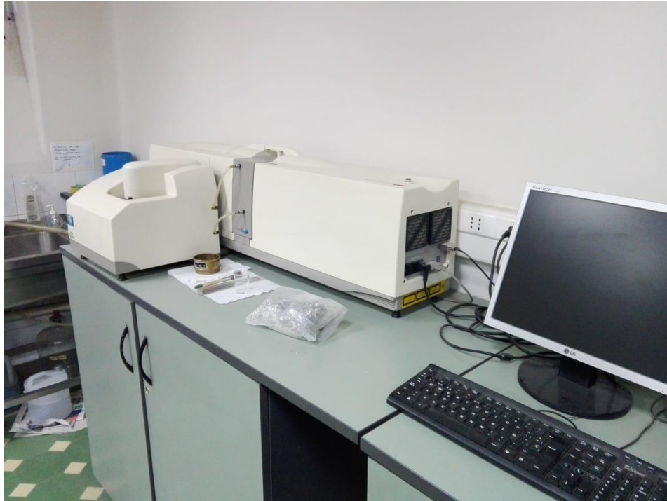
Figura 24. Malvern Mastersizer 2000 . Se puede observar el equipo que realizó el análisis granulométrico láser. Consiste en un tanque en donde se agrega el líquido y el sedimento, el cual se conecta mediante tubos, por donde pasan los granos, hacia el equipo láser en donde se produce la refracción del haz al tocar los granos. El control del equipo y procesamiento de los datos se realiza a través del software operado desde el PC contiguo.
