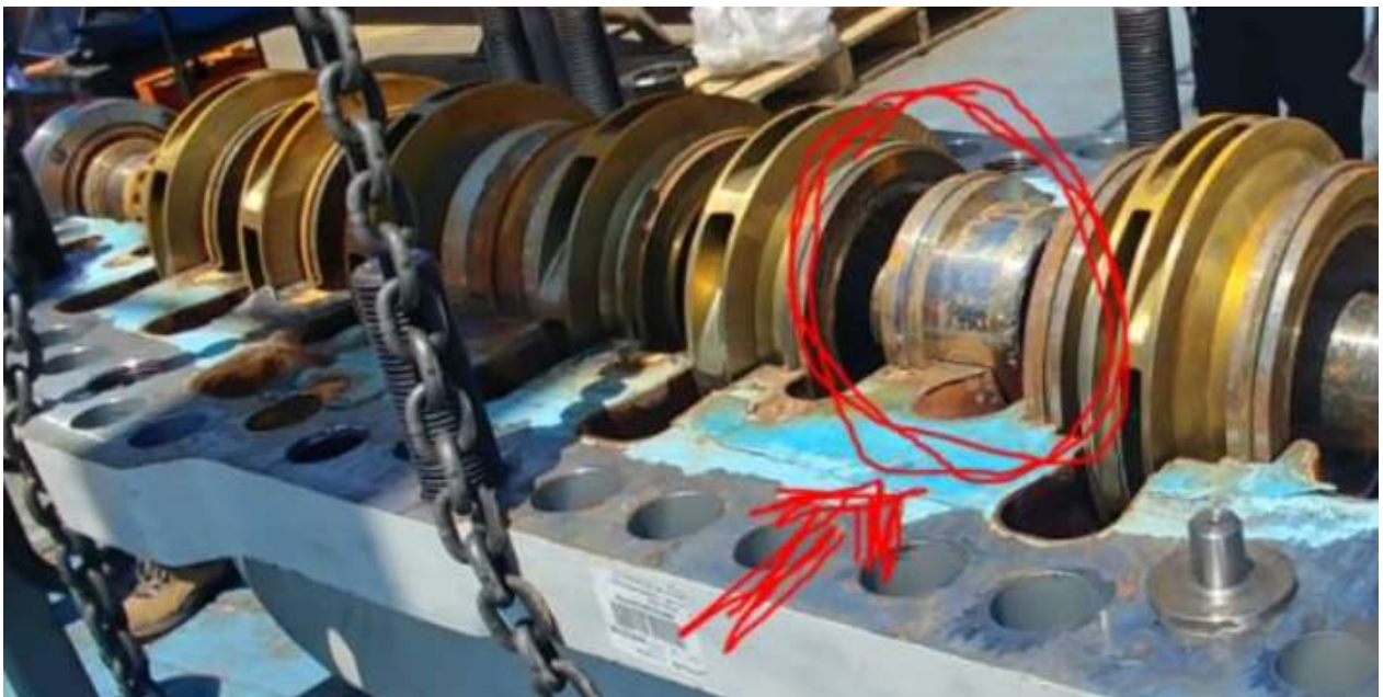
Figura 47: Descanso de desplazamiento axial que fallo generando una falla de la bomba
