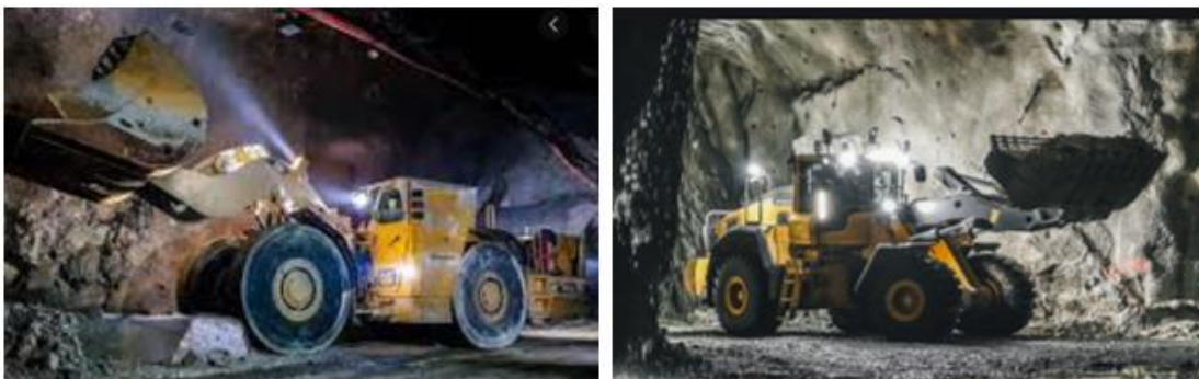
Imagen 5.6: equipos LHD y cargador frontal para minería subterránea respectivamente (Fuente: Métodos de excavación y voladura, UCHILE)
