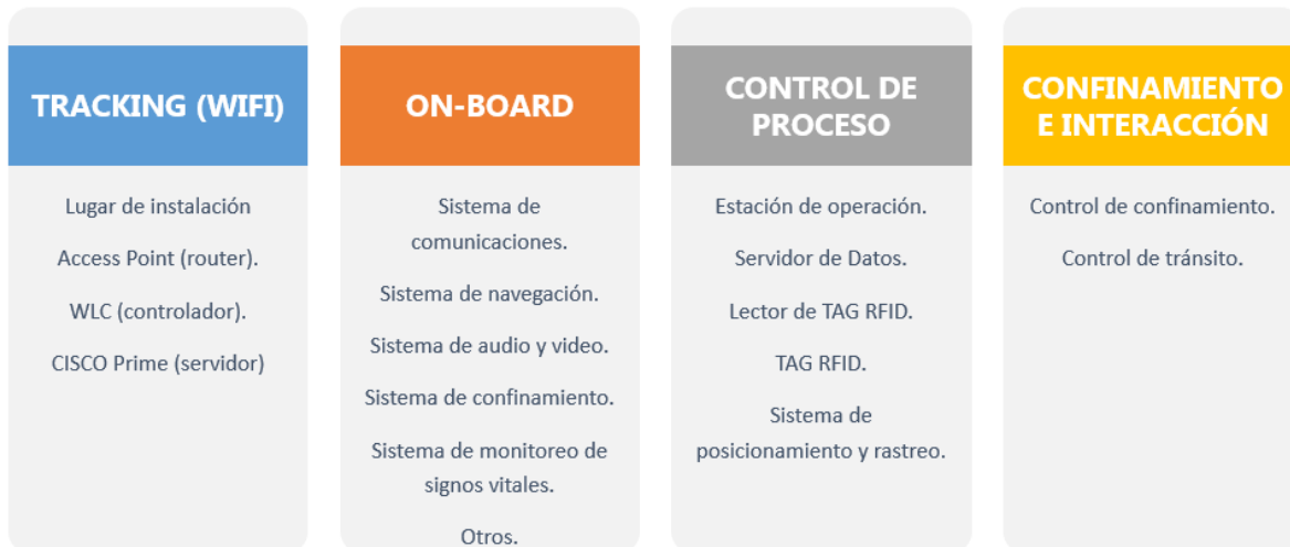
Imagen 5.8: principales componentes que conforman un proceso autónomo en minería subterránea (Fuente: JRI 2018).
