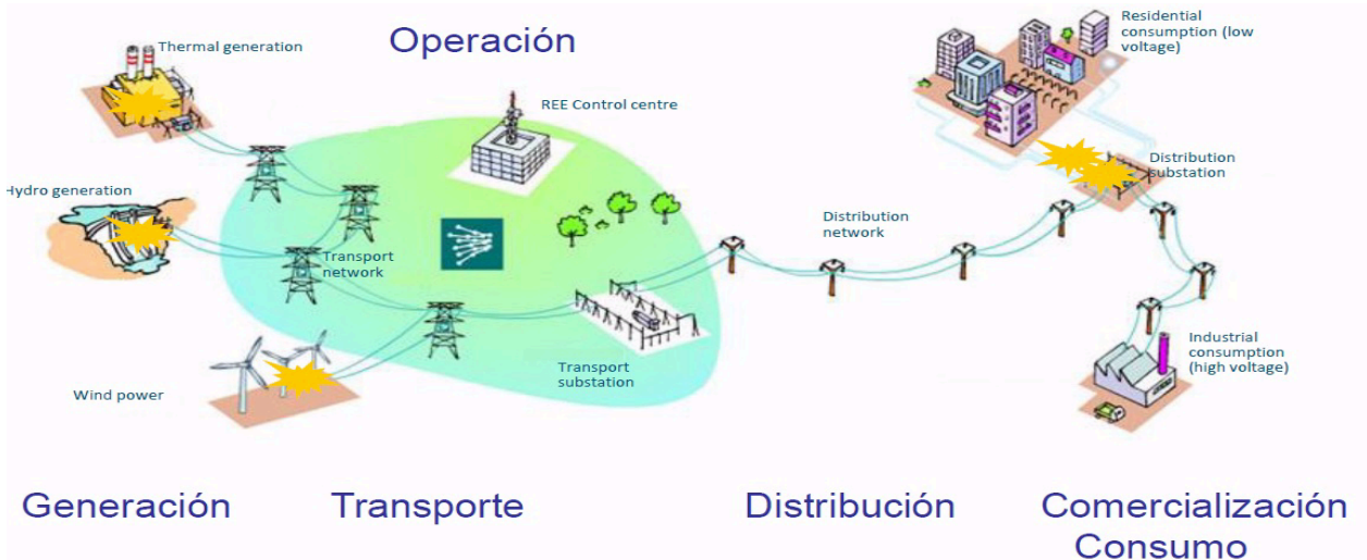
Ilustración A.1: Sistema Eléctrico de Potencia
