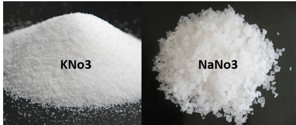
Figura 3.26: Sales fundidas, típicamente son mezclas de NaNO_3 y KNO_3 en diferentes concentraciones.
