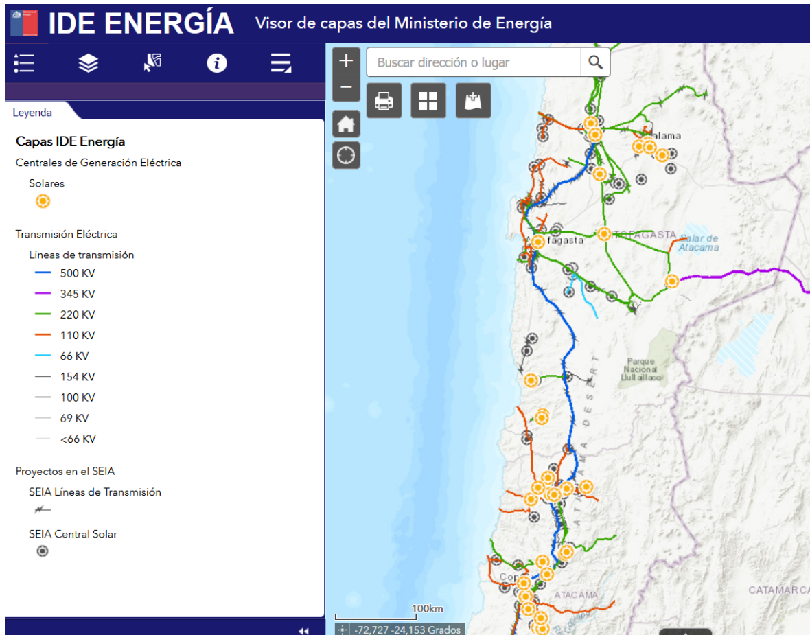
Figura 3.20: Ide o mapa de capas del Ministerio de Energía de Chile, las líneas de color representan líneas de transmisión actuales, las líneas negras son líneas de transmisión futuras (en SEIA), los círculos amarillos son centrales solares actualmente en operación, y los círculos negros centrales solares futuras (en SEIA), extraído de [31].
