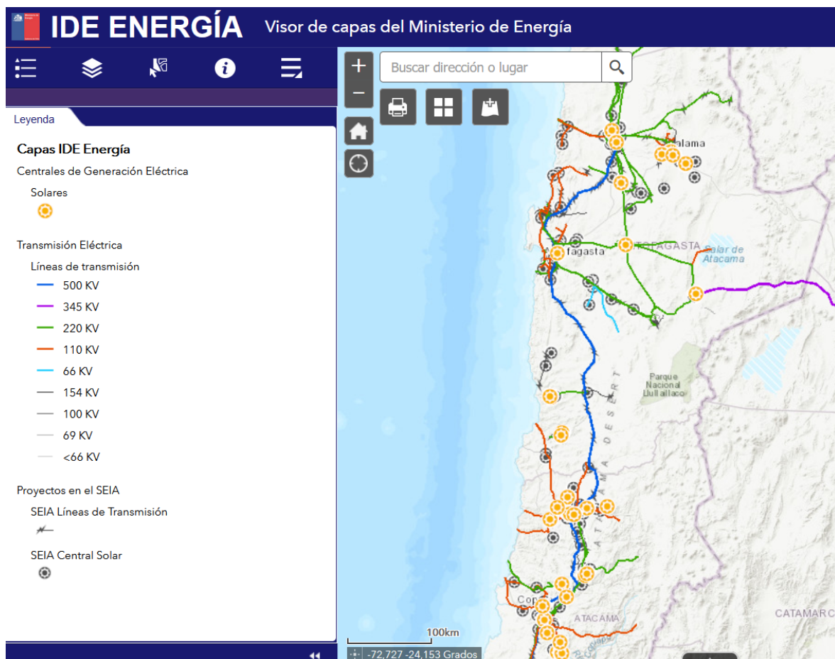
Figura 3.11: Ide o mapa de capas del Ministerio de Energía de Chile, las líneas de color representan líneas de transmisión actuales, las líneas negras son líneas de transmisión futuras (en SEIA), los círculos amarillos son centrales solares actualmente en operación, y los círculos negros centrales solares futuras (en SEIA), extraído de [31].
