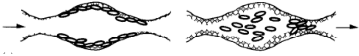
Figura 3.17: Representación gráfica de la Migración de arcillas inducida por el Hinchamiento [15].
