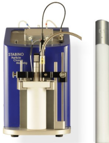
Figura 4.5: Equipo Stabino® Particle Metrix, utilizado para medición de potencial zeta y pistón de 100 nm usado en los experimentos.
