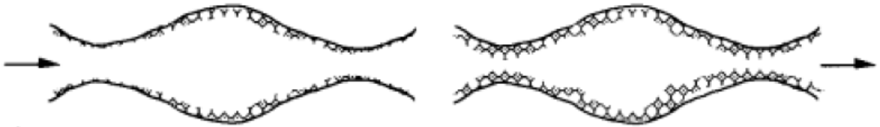
Figura 3.16: Representación gráfica del Hinchamiento de arcilla [15].
