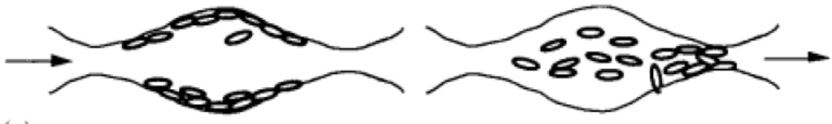
Figura 3.15: Representación de la migración de partículas ultrafinas [15].
