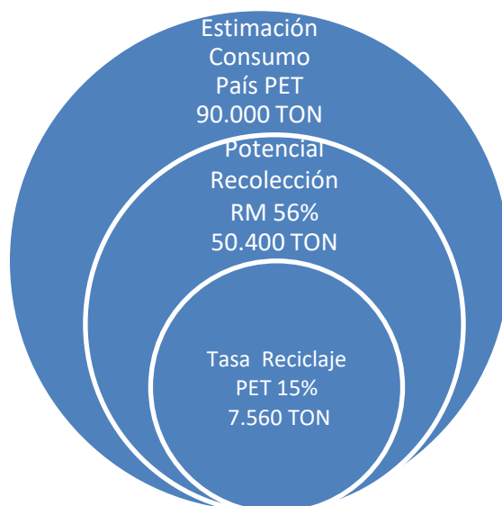
Ilustración 4. Secuencia de estimación del volumen de PET reciclado (Fuente: Propia)
