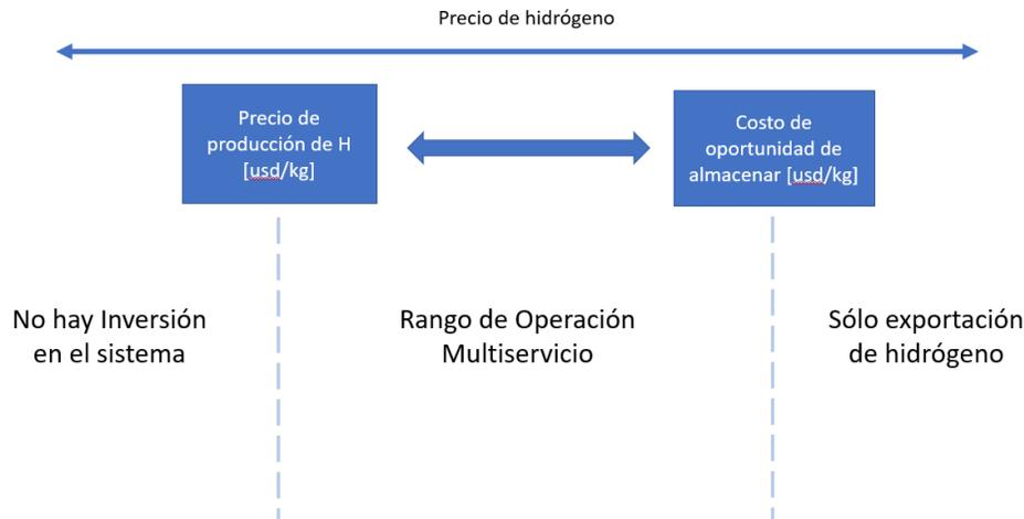
Figura 7.15: Esquema de Operación Multiservicio (Exportación y Almacenamiento).
