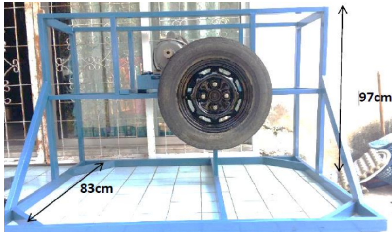
Figura 3.3: Plataforma experimental fabricada para medir desgaste ocurrido en un neumático y relacionarlo con variables operativas como presión, distancia y velocidad [23].
