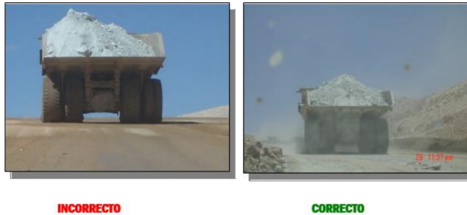
Figura 3.4: Distribución correcta de la carga en un camión de extracción, del “Manual de concientización de neumáticos” de la tesis de grado de Juan Ignacio Morales Navarro [24].
