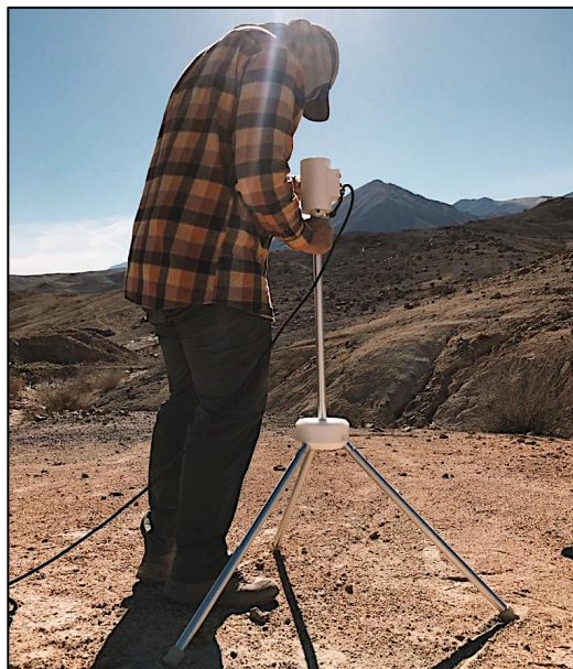
Figura 4.3: Magnetómetro Geometrics Modelo G-856 en la estación base.
