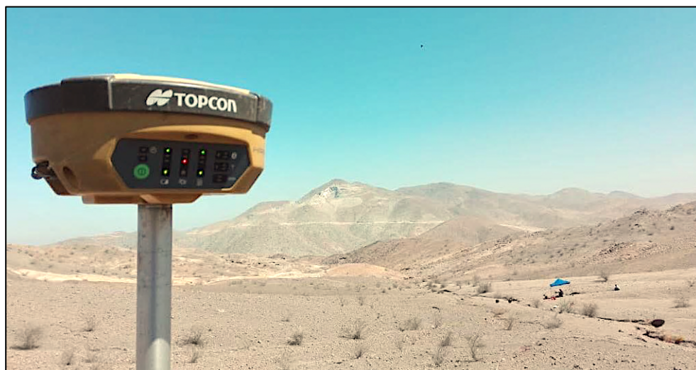
Figura 4.12: DGPS Hiper V Topcon determinando la posición de los electrodos.
