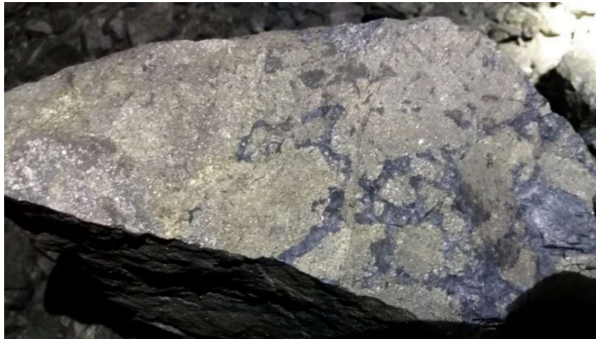
Figura 7 Mineralización de sulfuro masivo con parches de sílice en la mina El Roble. Fuente: Propia
