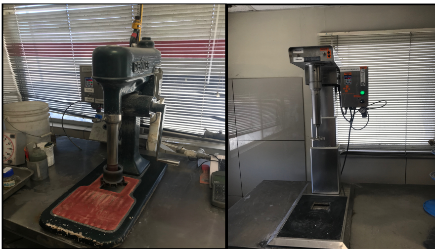
FIGURA 4.3: MÁQUINAS AIREADORAS DEL LABORATORIO METALÚRGICO DE LA MINA EL SOLDADO, QUE PERMITEN LA AGITACIÓN DE LA PULPA EN UN ENSAYO DE FLOTACION ESTÁNDAR.
