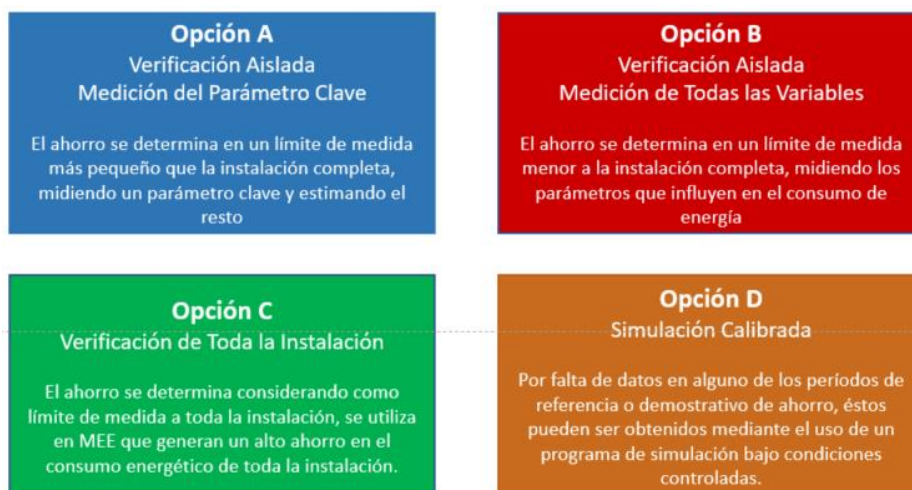
Figura 6 Opciones del IPMVP. Reproducción Propia. Fuente Medición y Verificación en la Gestión de Proyectos de Eficiencia Energética, AChEE, 2020
