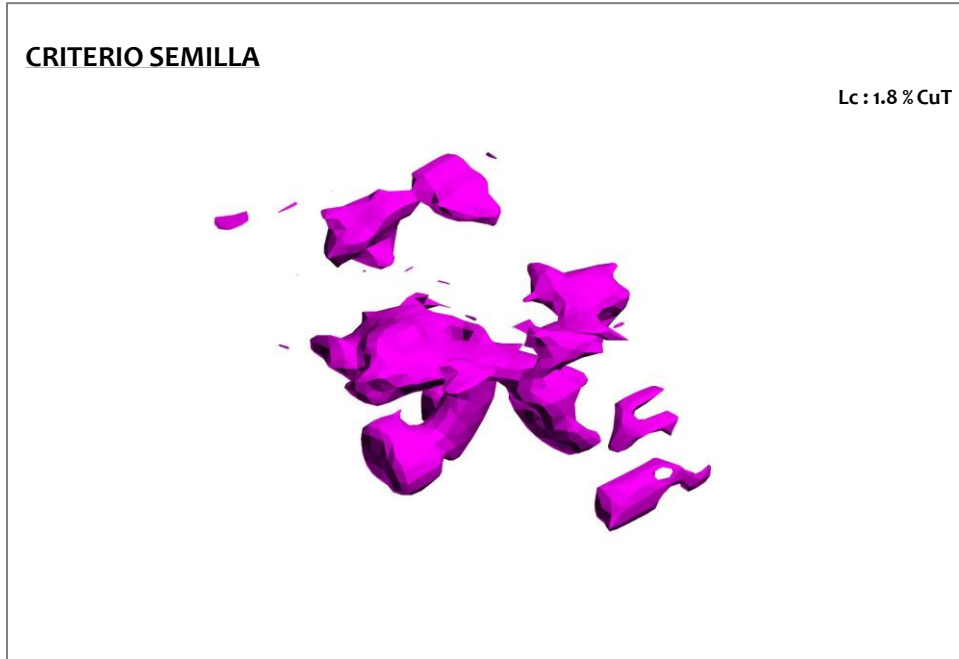
Figura 106: Visualización modelo de bloques con ley de corte 1.8% CuT
