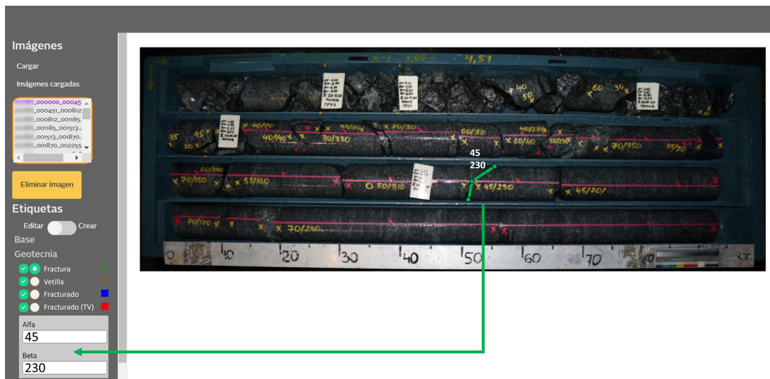
Figura 2.1: Aplicación desarrollada para etiquetar fracturas y tramos de roca muy fracturada a partir de imágenes de testigos de sondajes, con imagen del estudio de fracturas cargada.
