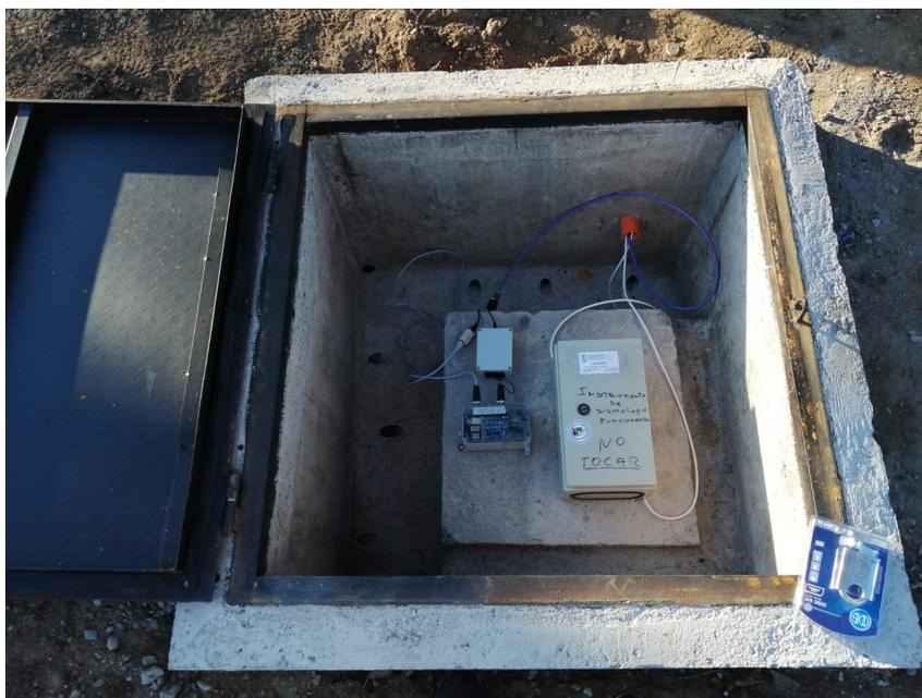
Figura 4.2: Instrumento R3323 Outdoor en pozo.
