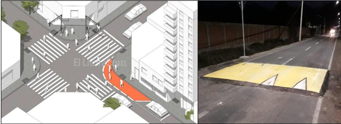
Figura 7-9: Esquema de demarcación de cruces peatonales en intersección (izquierda), Resalto reductor de velocidad (derecha)
