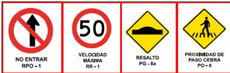
Figura 7-7: Señal reglamentaria de no entrar (izquierda), Señal reglamentaria de velocidad máxima 50 km/h (centroizquierda), Señal de advertencia de resalto (centroderecha), Señal de advertencia de proximidad de paso cebra (derecha)
