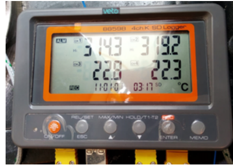
(b) Registrador de 4 canales con termocuplas.
