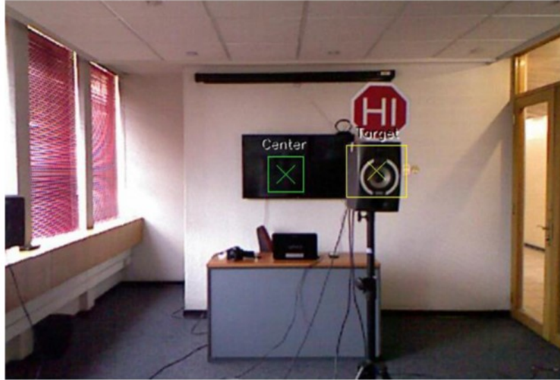
Figura 3.5: Image tracking usando YOLO [38], el rectángulo verde es el centro de la imagen y el rectángulo amarillo es la fuente de speech [2].
