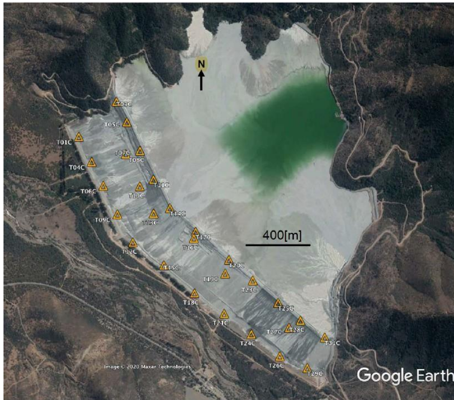
Figura 9: Red de geófonos ubicados en tranque de relaves 'El Torito'. (Pastén et al., 2019)
