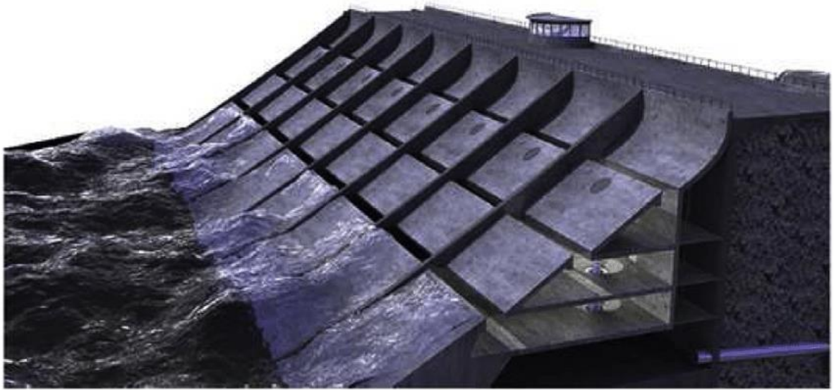
Figura I: Sección tipo del convertidor SSG (Vicinanza & Frigaard, 2008).
