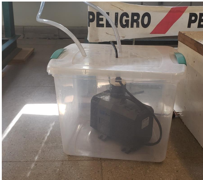
Figura 4.14. Bomba de inmersión y líneas de llenado y rebalse.
