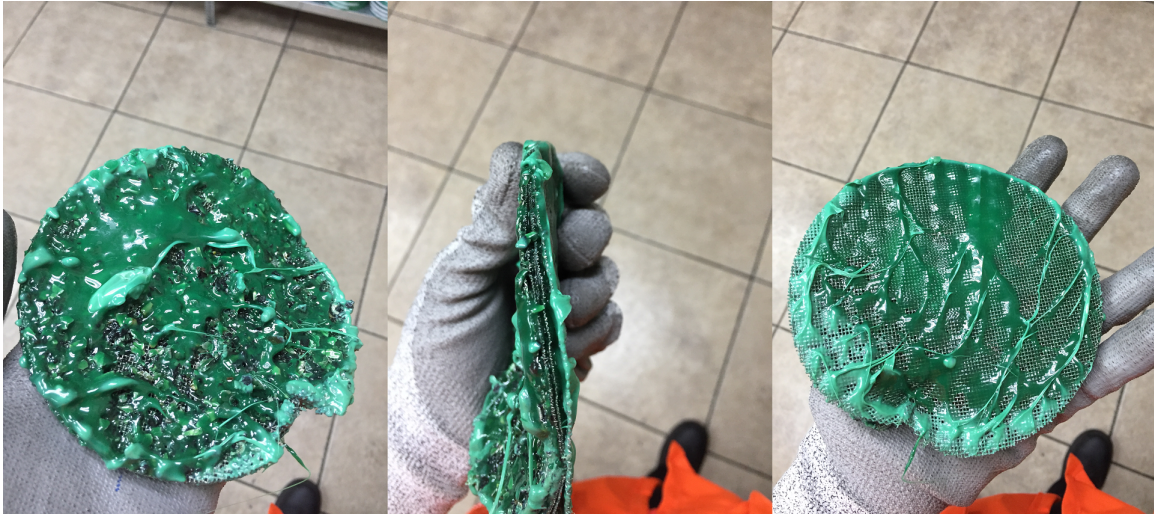
Figura 13.8: Filtro del horno de producción, a la izquierda se observan en su mayoría residuos metálicos, al medio la cantidad de filtros que hay y a la derecha se ve la limpieza del producto luego de aplicados los filtros. Fotografía
