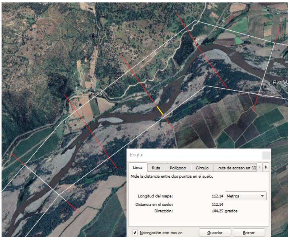
Figura 3-6: Determinación del ancho del cauce para el perfil MA26.
