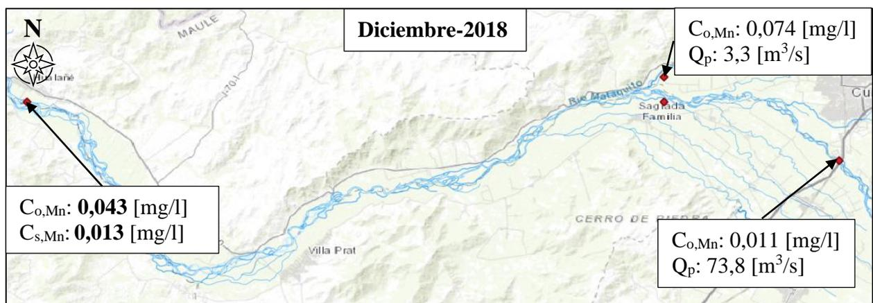
Figura 4-14: Esquema del caudal proyectado (Q<sub>p</sub>), la concentración observada de Mn (C<sub>o,Mn</sub>) y la concentración de Mn simulada (C<sub>s,Mn</sub>) en diciembre de 2018.
