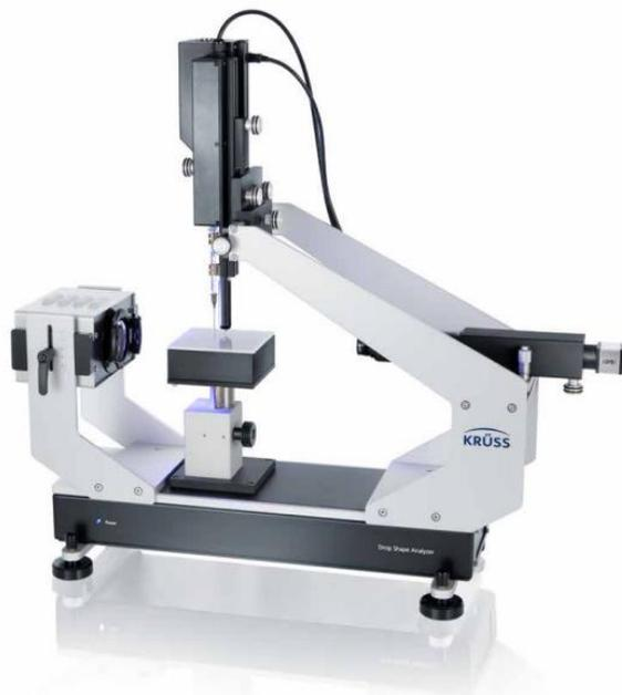
Figura 3.3.- Equipo Drop Shape Analyzer-DSA25E (KRÜSS Scientific).
