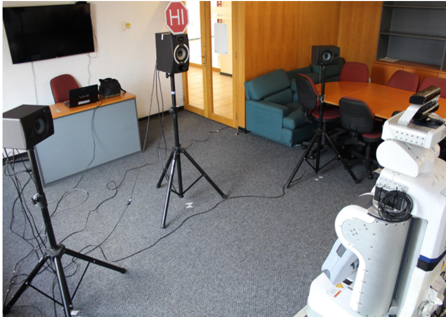
Figura 2.9: Escenario robótico móvil propuesto con el robot PR2, la fuente de voz y de ruido externo.
