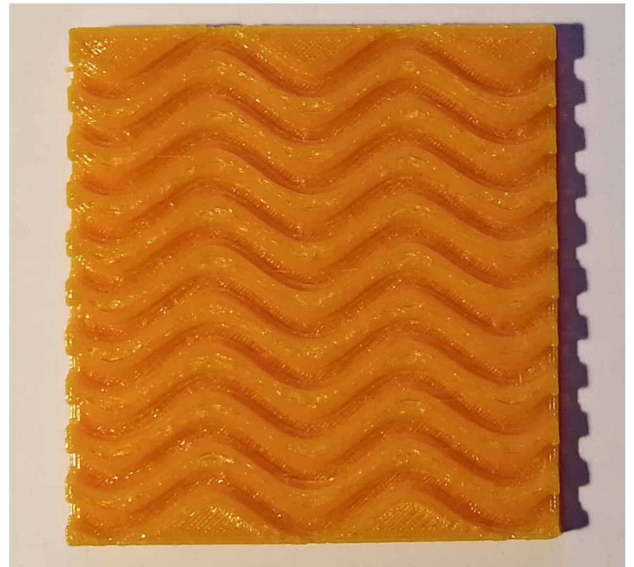
Imagen 20: primer cliché de PLA, realizado mediante impresión 3D, tenía como objetivo traspasar su textura al papel, generando relieves en forma de ondas.
