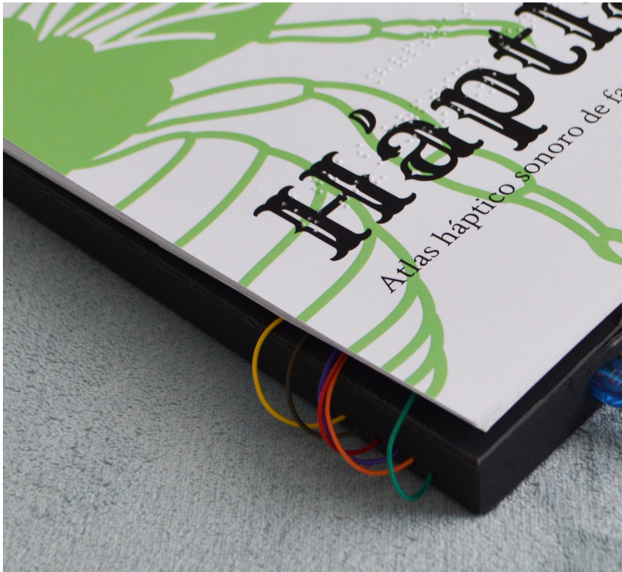
Imagen 83: se aprecian pequeños orificios en la caja por donde salen los sensores de audio táctil hacia cada lámina.
