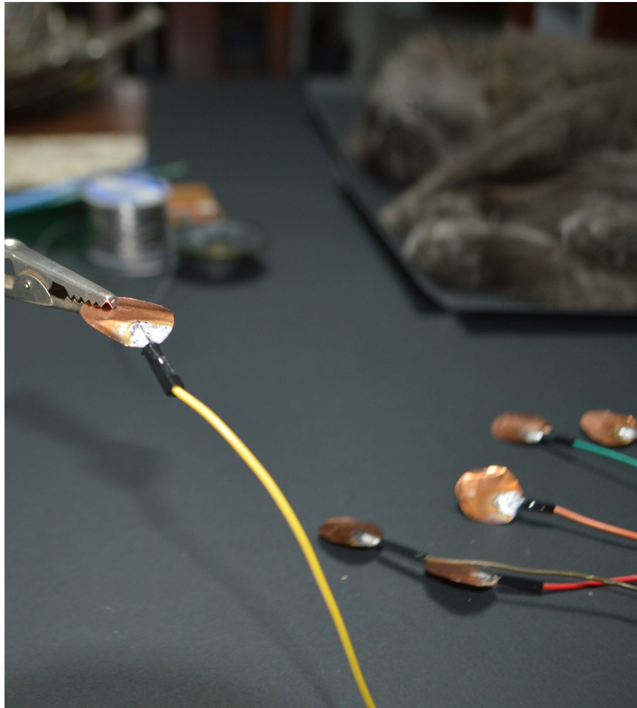
Imagen 18: para mejorar la sensibilidad de los sensores táctiles se soldó a cada uno de ellos un pequeño círculo de lámina de cobre.
