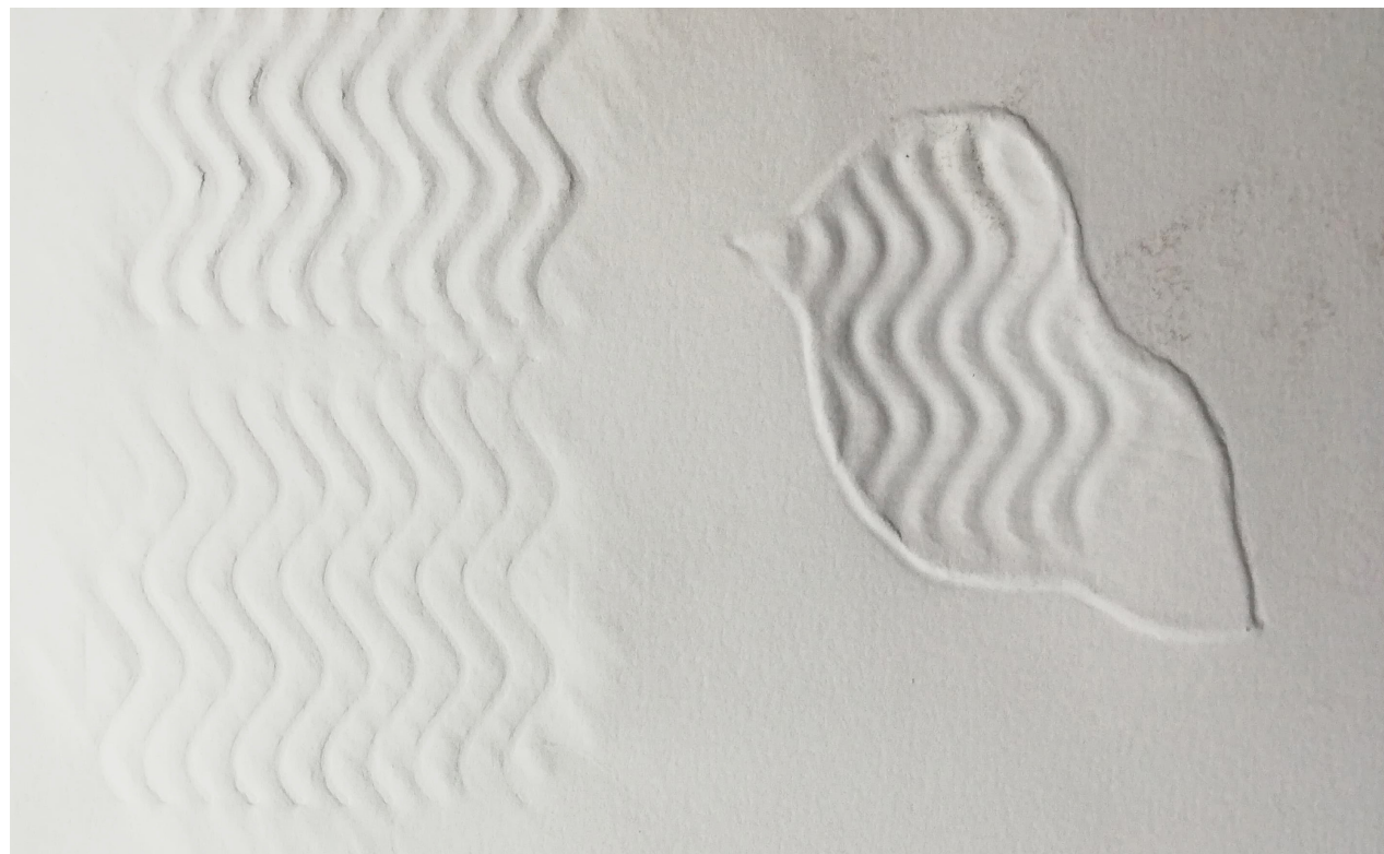
Imagen 21: testeo del cliché, como textura aislada y también como textura selectiva en una pequeña ilustración.
