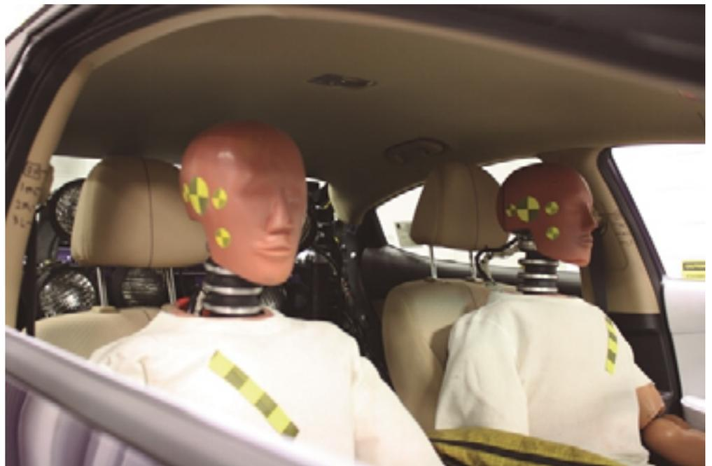
*Fig. 73. Modelos Dummies en un test de manejo*
