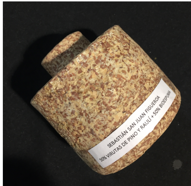
Fig. 73 Material biobasado de bioespuma + viruta. Elaboración propia.
