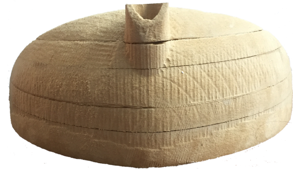
Fig. 69 Resultado de la base impresa en router cnc. Elaboración propia.
