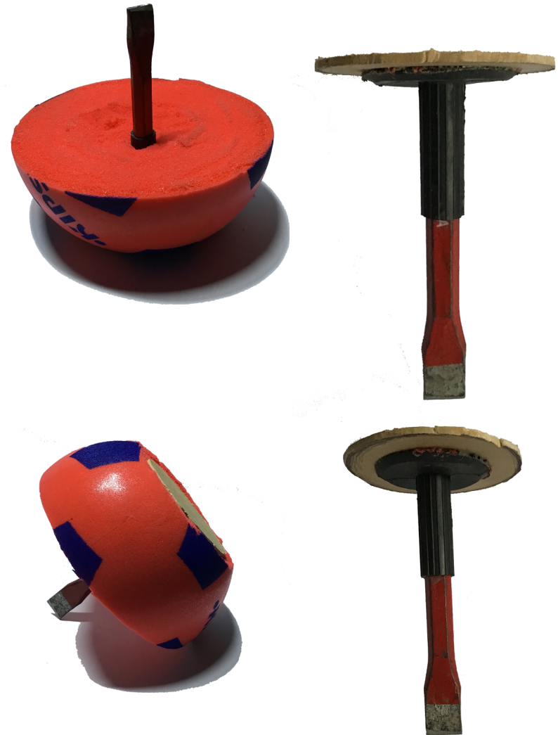
Fig. 49 Semiesfera y punta modificadas para prueba. Elaboración propia.
