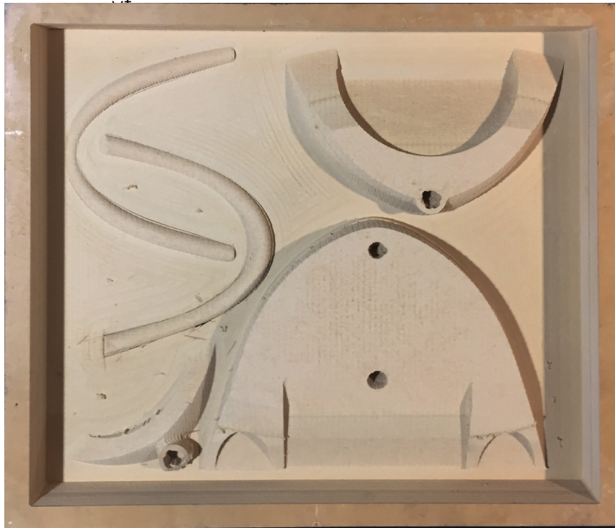
Fig. 68 Base impresa en stock por router cnc. Elaboración propia.
