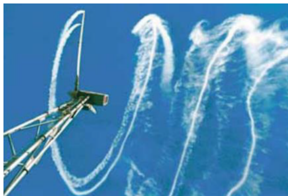
Figura 2.17: Efecto estela de un aerogenerador.
