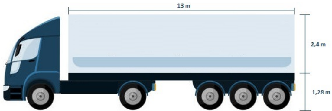
Figura 5.20: Máximas dimensiones del contenedor para el transporte de los cilindros de oxígeno gaseoso.
