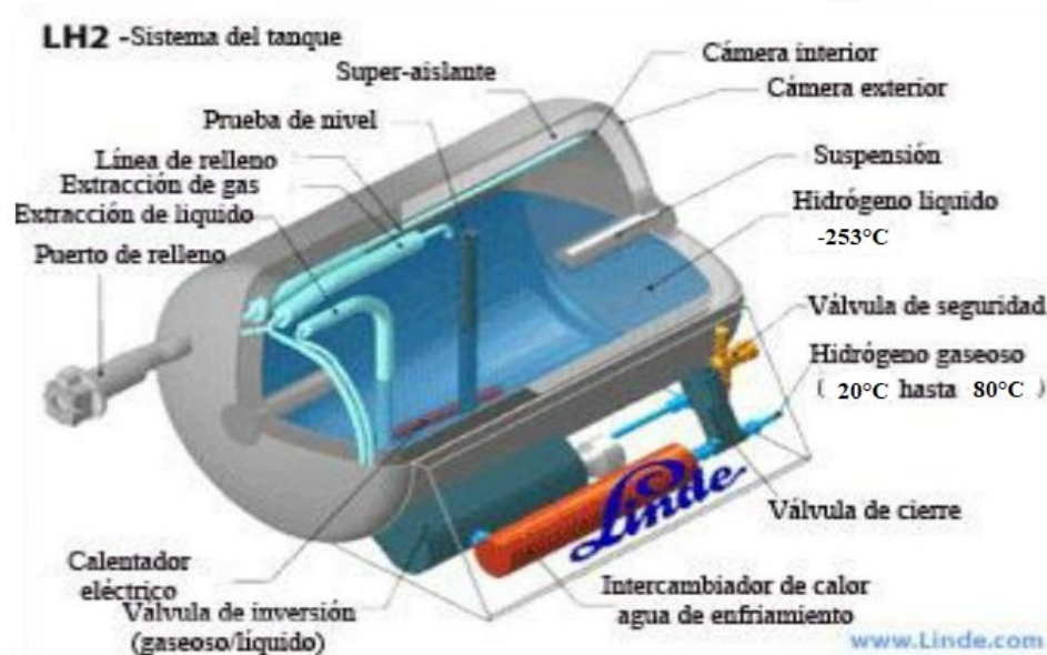
Figura 2.36: Representación esquemática de un vaso criogénico, diseño y componentes [15].
