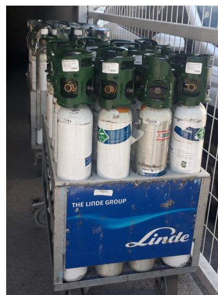
(d) Cilindro de 1 Nm^3 unidad mediliv, con regulador integrado y flujómetro. Manómetro y nivel.
