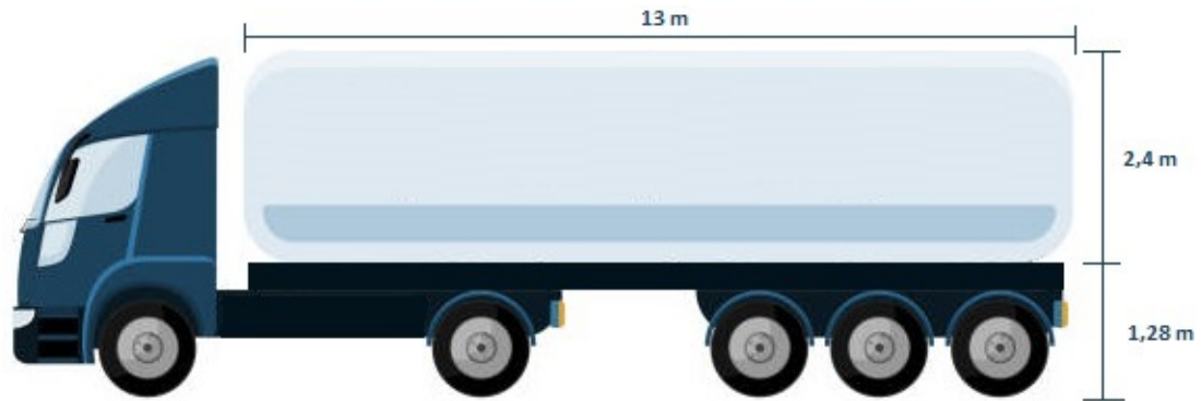
Figura 5.21: Máximas dimensiones de los estanques cilíndricos para el transporte de los compuestos.
