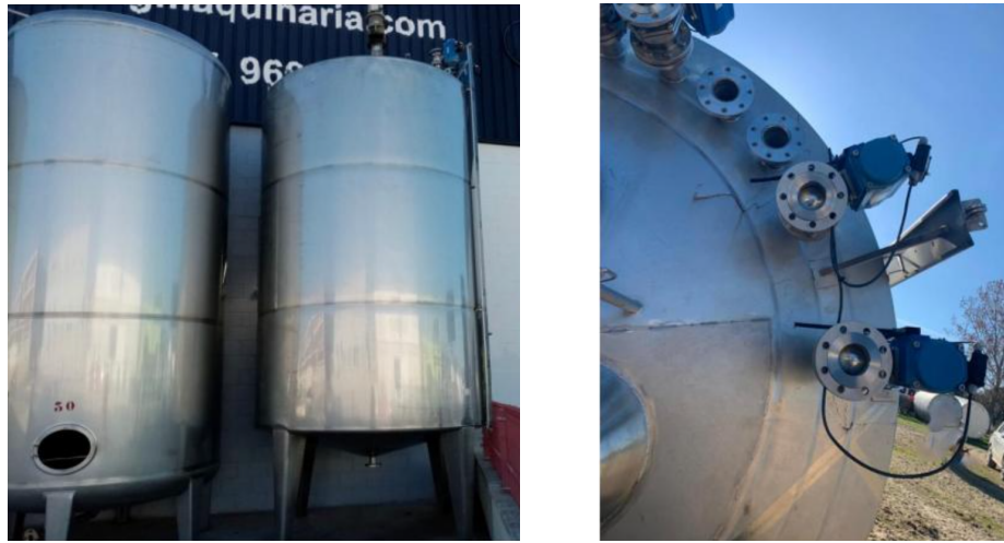
Figura 4.17: Estanque de mezcla con agitador.
