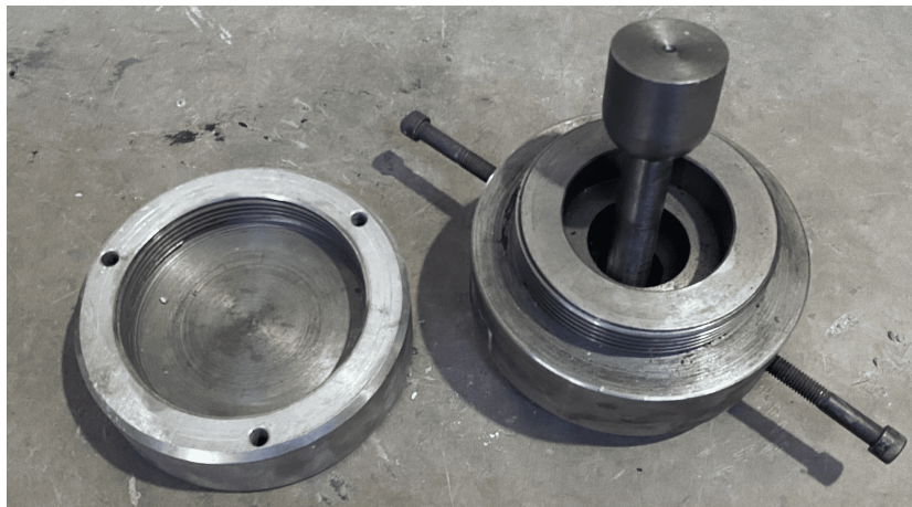
Figura 3.14: Dispositivo empleado en ensayos de tracción directa.
