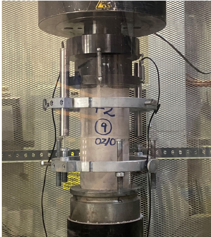
Figura 3.11: Montaje experimental, ensayo de fatiga en compresión.
