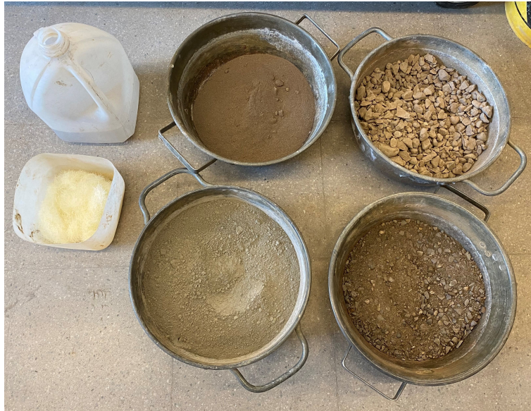
Figura 3.9: Materiales empleados en la elaboración de tres probetas cilíndricas de hormigón.
