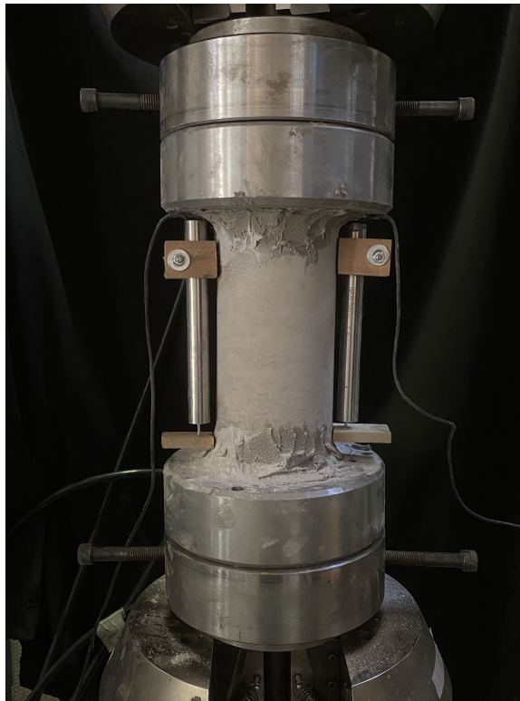
Figura 3.15: Montaje experimental, ensayo de tracción directa.
