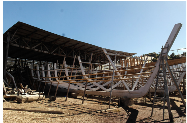
Figura 130 Construcción embarcación en etapa de plantillas Fuente: Colección de la autora (marzo 2021)
