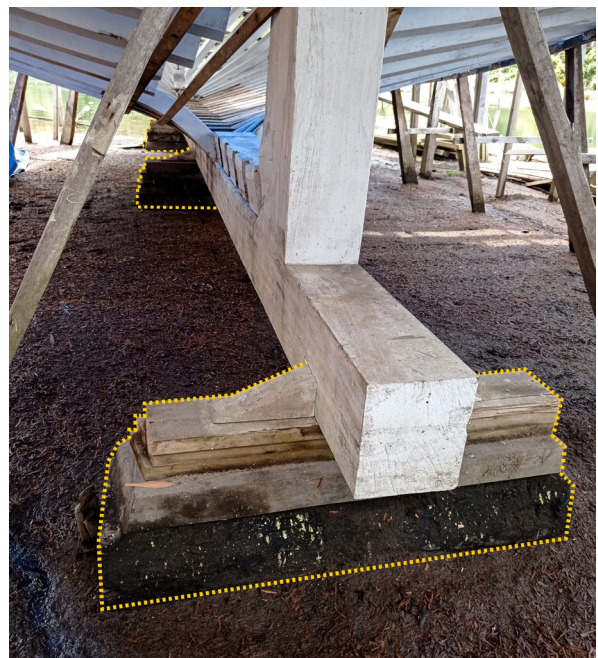
Figura 204 Picaderos: elementos donde se apoya la quilla Fuente: Elaboración propia 2021
