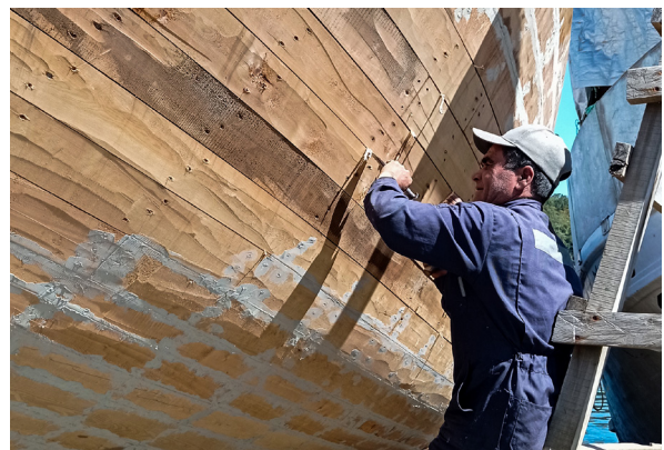
Figura 139 Estopado o calafateo embarcación Fuente: Colección de la autora (octubre 2021)
