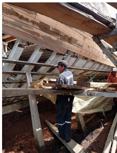
Figura 137 Entablado del casco Fuente: Colección de la autora (octubre 2021)
