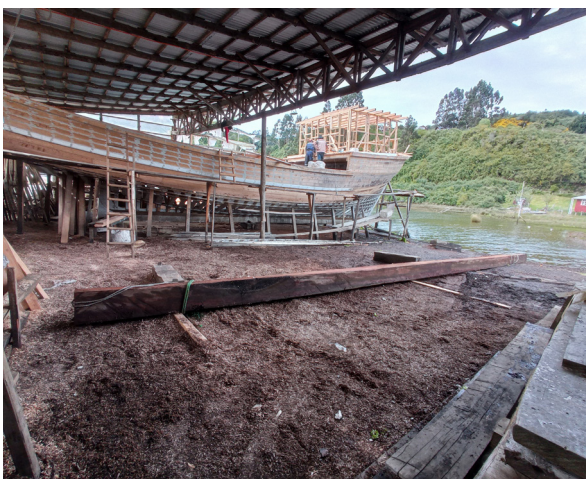
Figura 125 Traslado de quilla a zona de construcción Fuente: Colección de la autora (octubre 2021)
