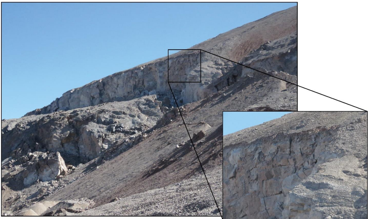
Figura 58: Cálculo de GSI a través de fotografía del escarpe principal con roca expuesta
