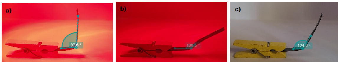
Figura 5.16: Ciclo de actuación bicapa PLA+ MoS_2 y Papel expuesta a ciclos de radiación infrarroja mediante una lampara a 12 cm por 10 segundos. a) 0 s, b) 10 s y c) 60 s. El color rojo representa las muestras siendo irradiadas.
