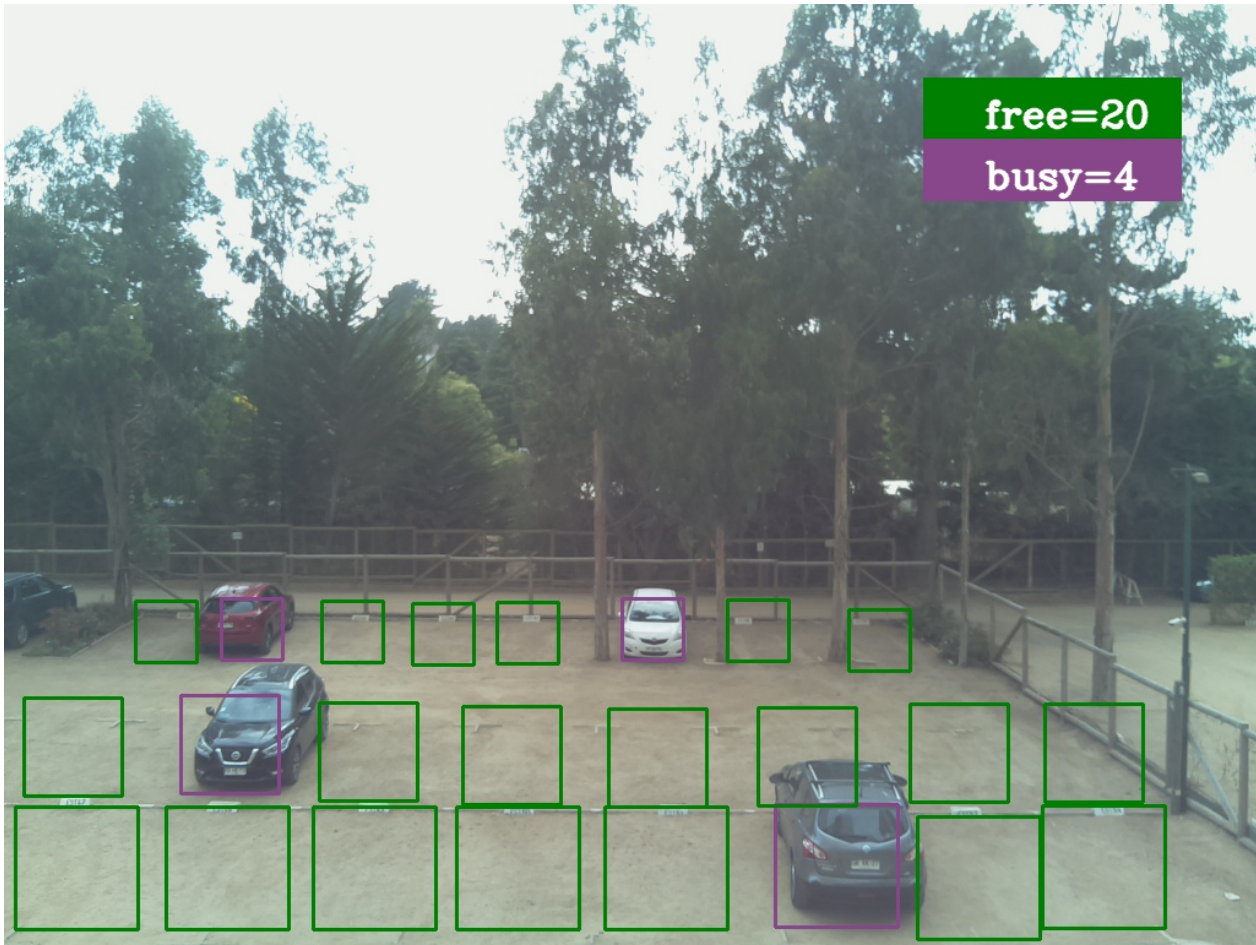
Figura 5.5: Ejemplo del algoritmo de detección aplicado a una captura de imagen de estacionamiento durante el día.
