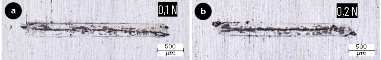
Figura 4.12: Pistas de desgaste de la referencia con 2,5mm/s y carga normal de: (a) 0,1N; (b) 0,2N.
