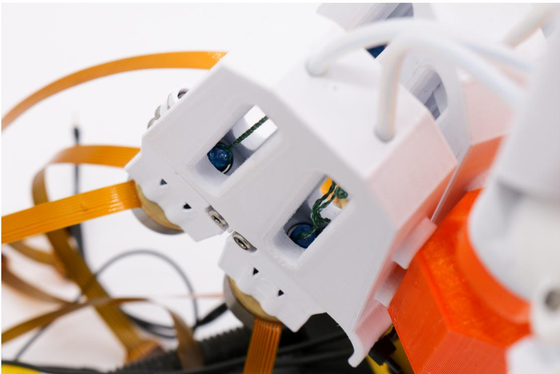
Figura 4.22: Fotografía del detalle del sistema TSA extensor y flexor del dedo índice.
