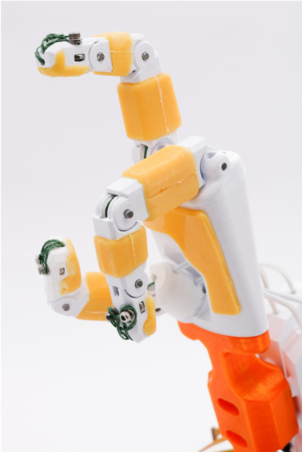
Figura 4.20: Fotografía del detalle de los dedos y sus fundas de silicona
