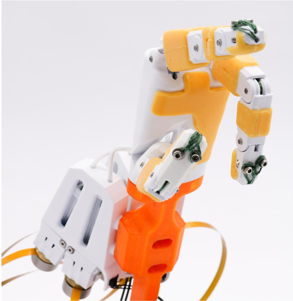
Figura 4.19: Fotografía del sistema armado con antebrazo, mano y sistemas de actuación para los tres dedos.
