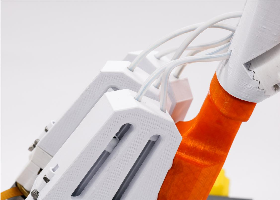
Figura 4.21: Fotografía del detalle de las guías de los tendones entre los TSA y la mano.
