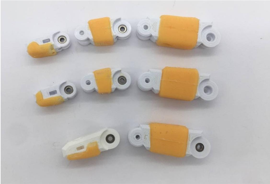
Figura B.3: Falanges de los dedos medio (arriba), índice (al medio) y pulgar (abajo) con las funda de silicona luego de terminado el proceso.
