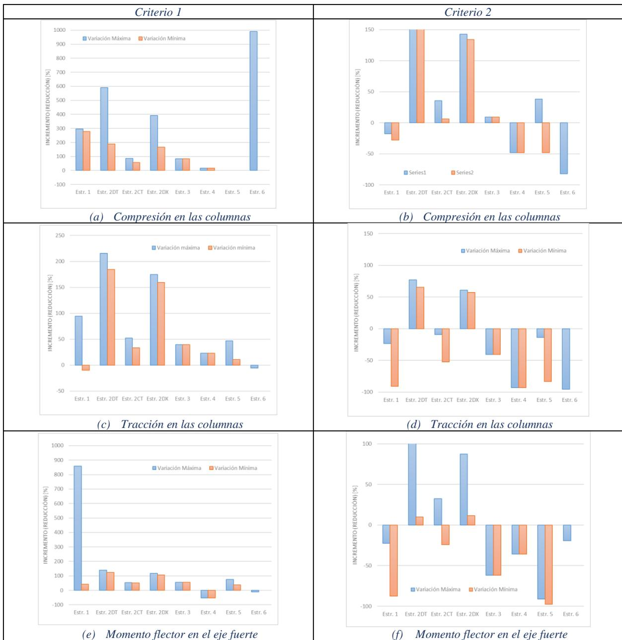
Figura 6-11: Incremento (disminución) en fuerzas para el diseño de empalme de columnas
