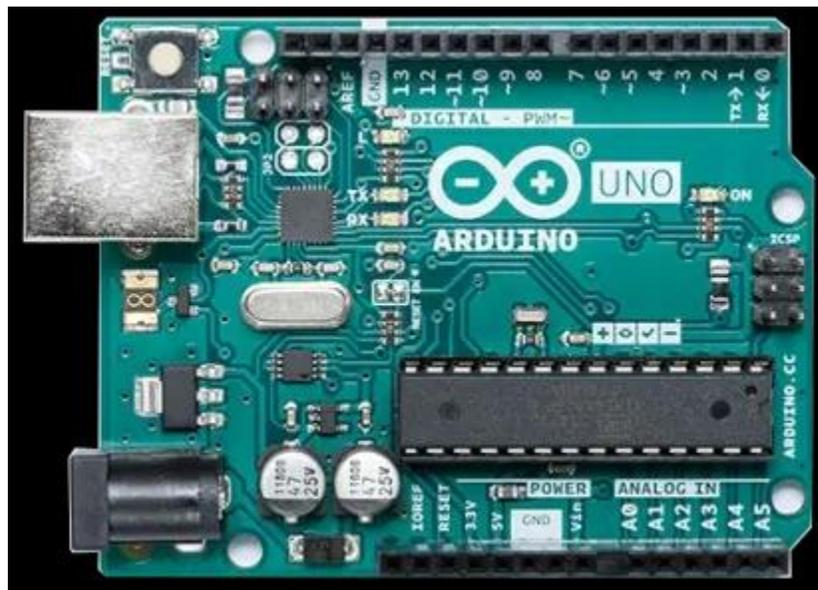
Figura 1. Placa arduino UNO [10]
