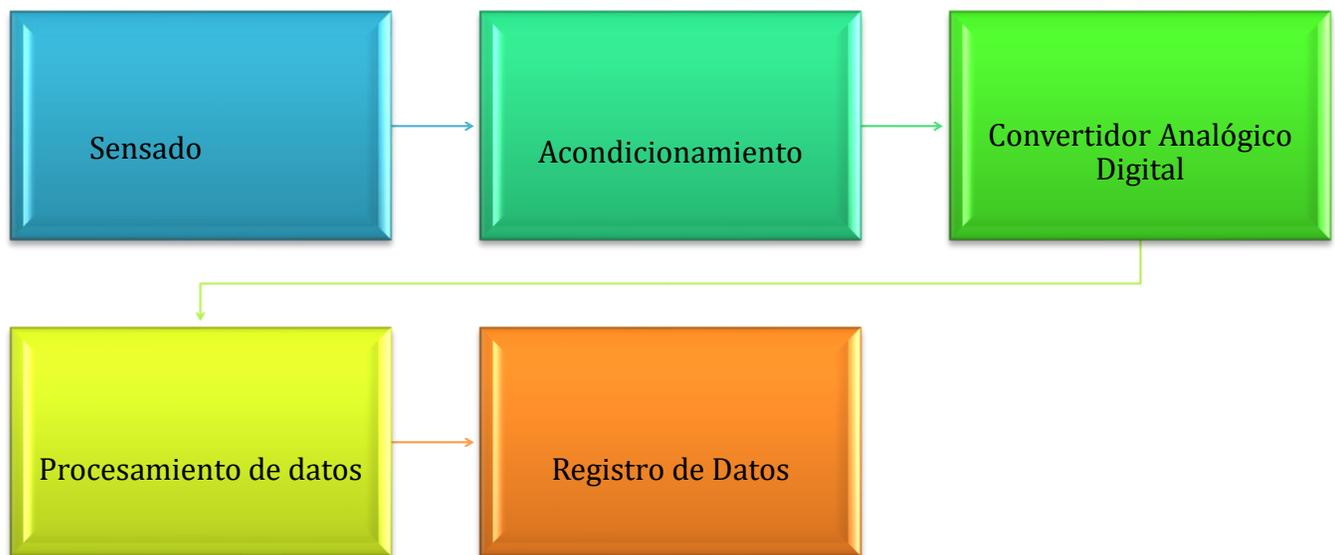
Figura 5. Diagrama de bloques del sistema
