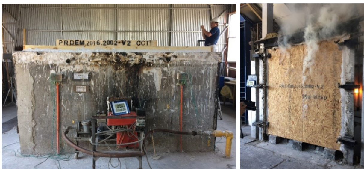
Figura 4.5: Ensayo NCh 935/1, estructura entrepiso (a la izquierda) y muro (a la derecha). Fuente: Idiem, 2018.
