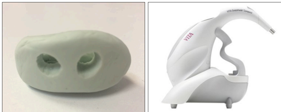
Figura 4. (A) Fotografía de llave de silicona individual con orificios para medición en incisivos centrales superiores. (B) Espectrofotómetro VITA EasyShade Compact (Bersezio y cols., 2014).
