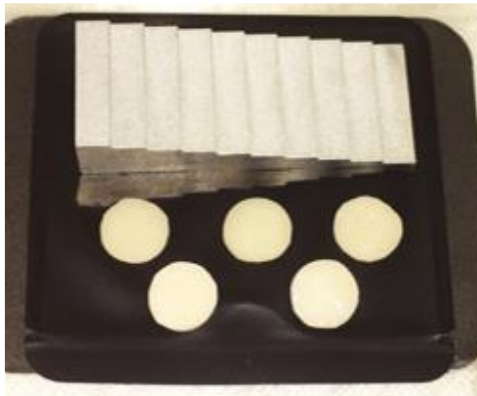
Figura 4. Cuerpos de prueba y cuña escalonada de aluminio sobre película PSP (Fotografía cortesía de Vega V.)
