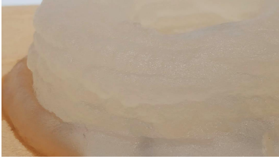
A. 46: Prueba de temperatura en impresión 3D. Agar-agar 80 [°C] acercamiento de capas.
