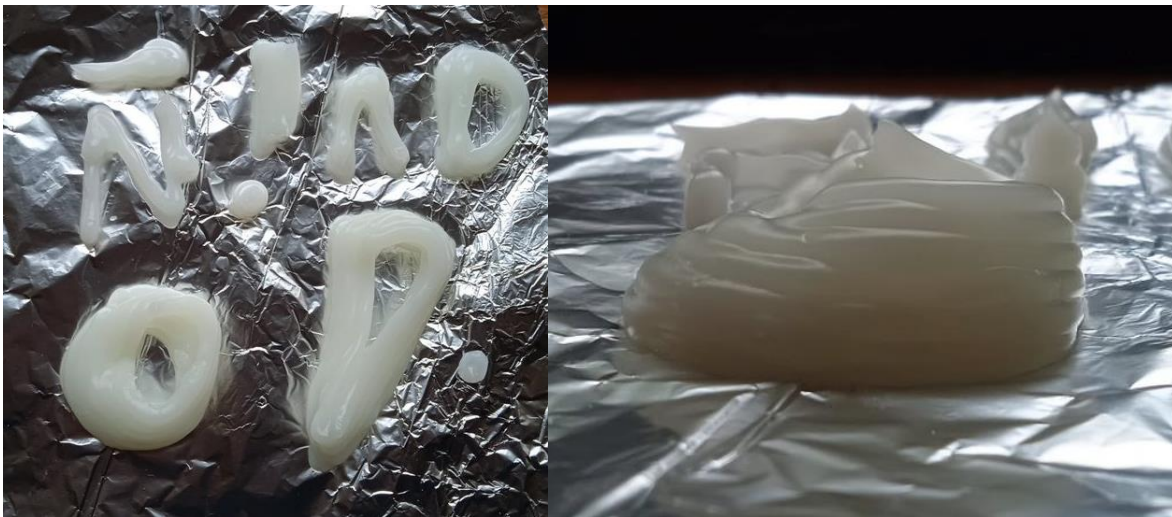
a) b) Figura 18: Generación de capas con bioplástico a base de almidón. Elaboración propia
