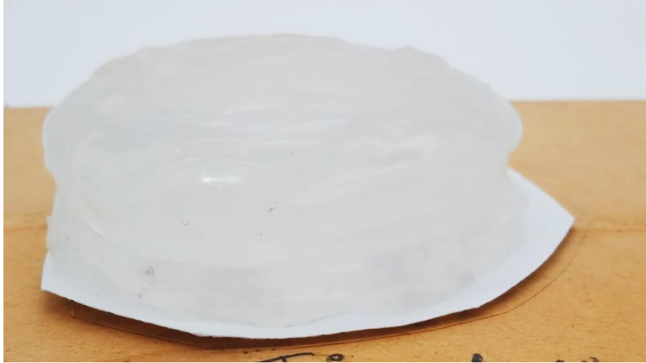
A. 56: Prueba de temperatura en impresión 3D. Almidón 100 [°C] acercamiento de capas.
