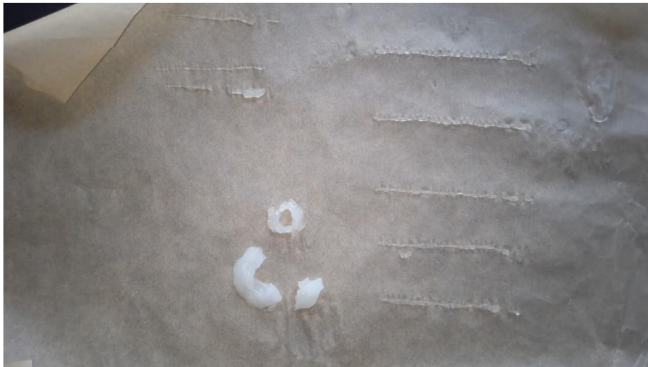
A. 11: líneas secas de bioplástico almacenado durante 2 días en jeringas.
