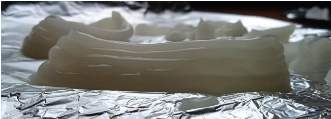
A. 4: Experimento generación de capas con almidón. cuerpo triangular vista lateral.
