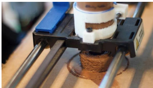
Figura 4: Bioprinter, cabezal de extrusión. Fuente Fablab U. de Chile
