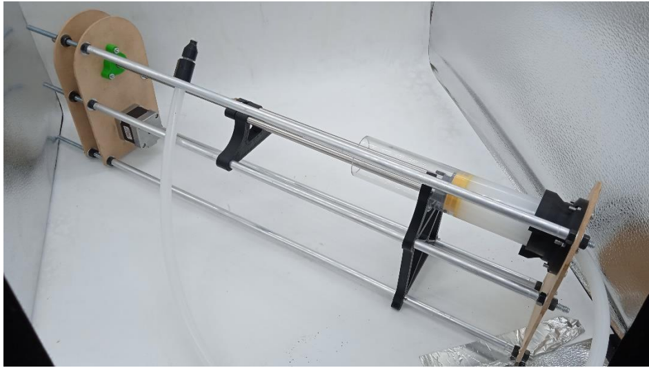
A. 30: Primer modelo de sistema de extrusión
