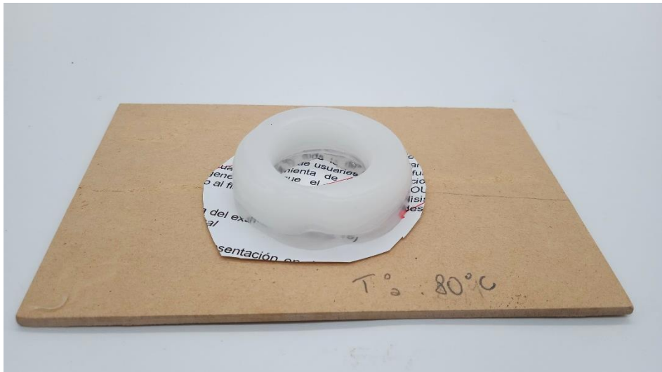
A. 49: Prueba de temperatura en impresión 3D. Almidón 80 [°C]
