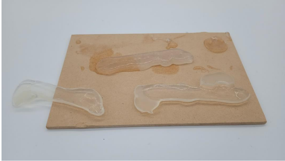
A. 24: prueba de calentado posterior agar-agar . 100 [°C] separación de capas por que el proceso de retrogradación superficial es demasiado rápido
