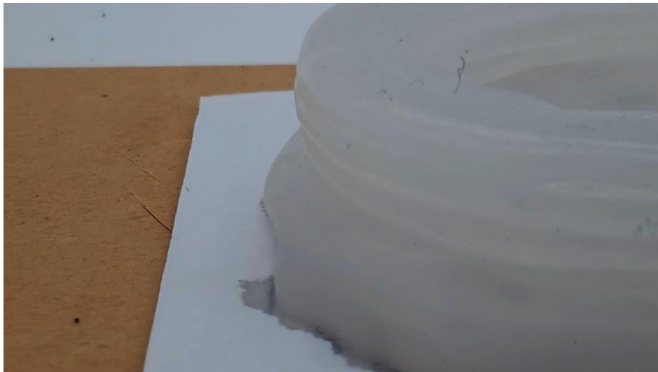
A. 61: Receta ST-W060-0600, 80 [°C] acercamiento de capas.
