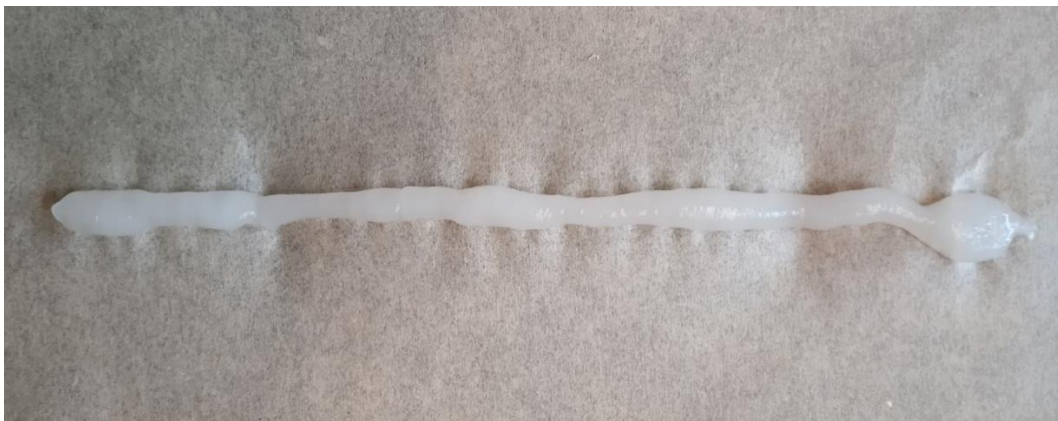
Figura 22: Línea de bioplástico a base de almidón almacenada en jeringa durante 2 días.
