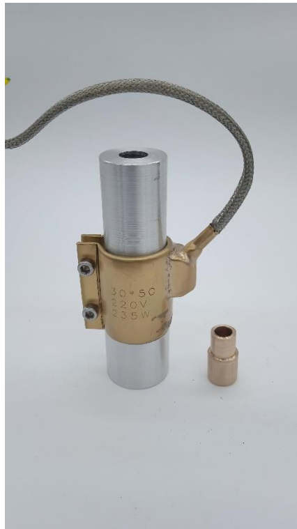
A. 41: Extrusor previo a la mecanización de roscas
