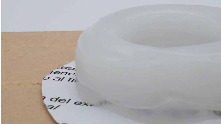
A. 50: Prueba de temperatura en impresión 3D. Almidón 80 [°C] acercamiento de capas.
