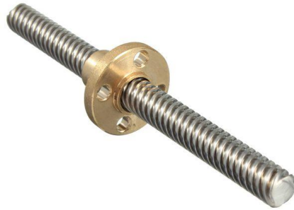
Figura 32: Husillo TR8 con paso de 2[mm] y 4 hilos con su tuerca de latón. Imagen referencial
