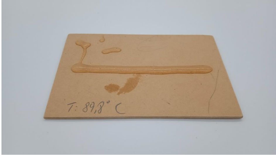
A. 22: prueba de calentado posterior agar-agar. 90 [°C]
