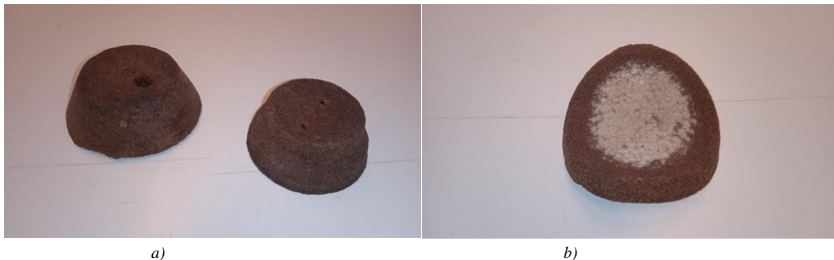
Figura 5: Biomaterial a base de borra de café. a la izquierda se puede observar el material con conservante en su receta. A la derecha, el mismo biomaterial sin conservante que formó un hongo en su superficie (sector blanco). Fuente: elaboración Propia.
