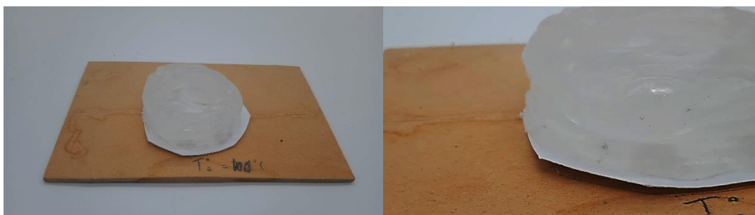
Figura 53: Impresión de bioplástico a base de almidón a 100 °C
