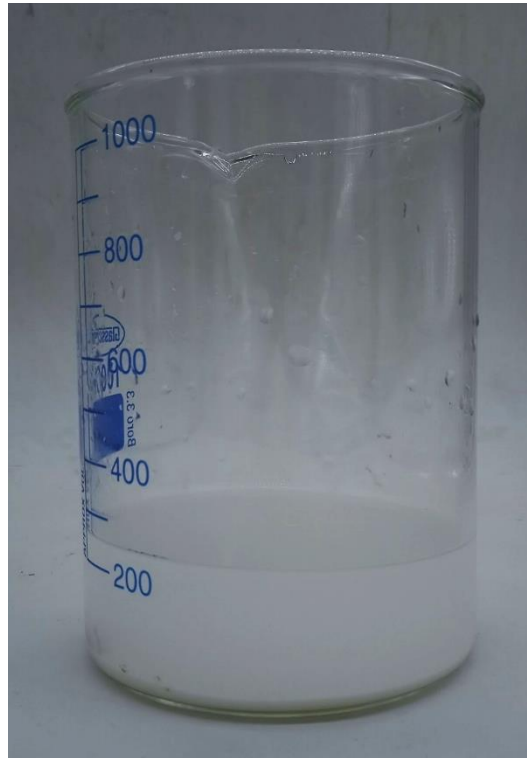
A. 17:A. 16: Prueba de decantación con receta ST-W060-0606 a 45 [°C]
