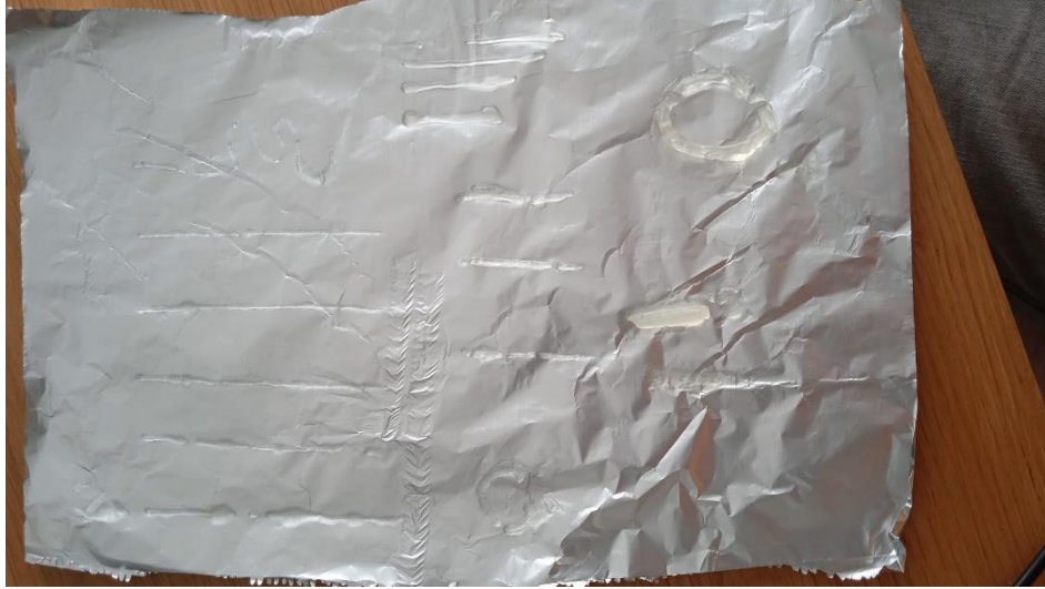
A. 12: Líneas secas realizadas con bioplástico con 5 días almacenado en jeringa.
