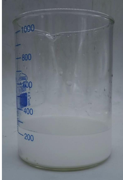
A. 16: Prueba de decantación con receta ST-W060-0606 a T^\circ ambiente.
