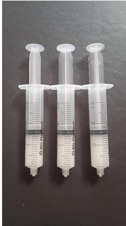
A. 6: Bioplástico a base de almidón almacenado en jeringas para prueba.
