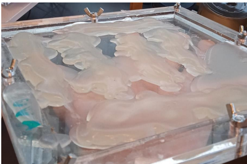
Figura 19: Generación de capas con agar-agar
