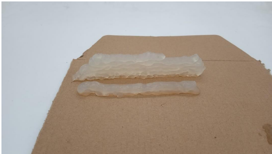
A. 13: Línea con bioplástico a base de Agar Agar. Almacenada durante 3 días.
