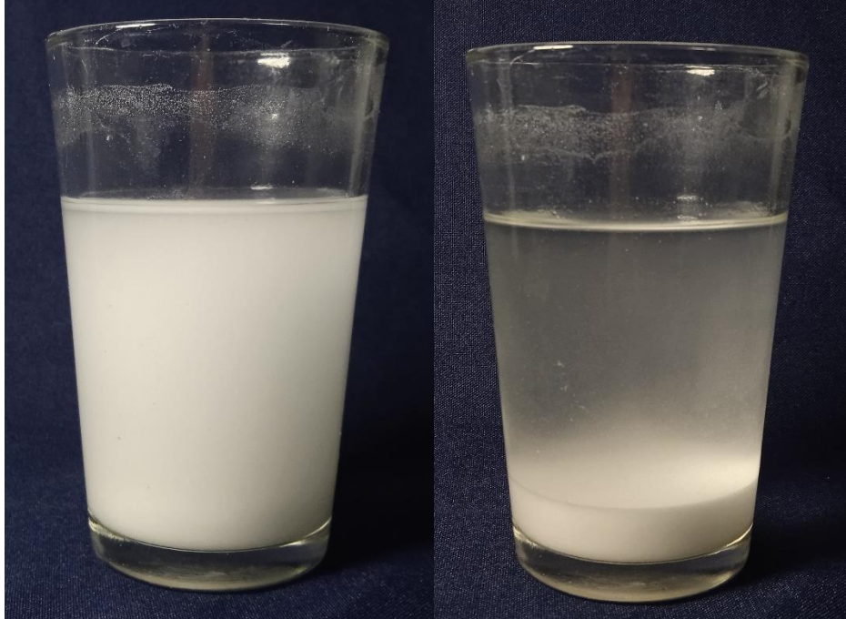
Figura 20: Decantación de mezcla de bioplástico a base de almidón calentada hasta 45 °C, con un tiempo de reposo de 3 [min]
