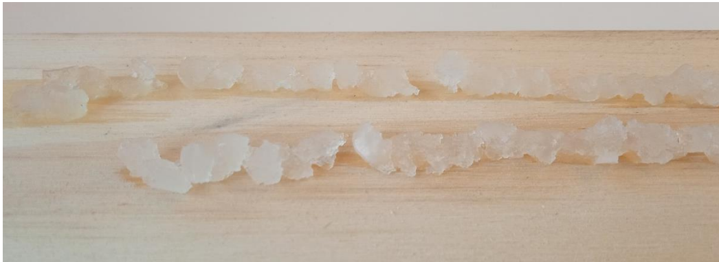
Figura 23: Línea de bioplástico a base de agar-agar almacenada en jeringa durante 3 días.
