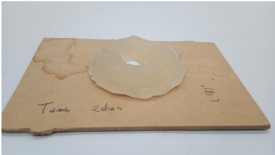
A. 47: Prueba de temperatura en impresión 3D. Agar-agar 90 [°C]
