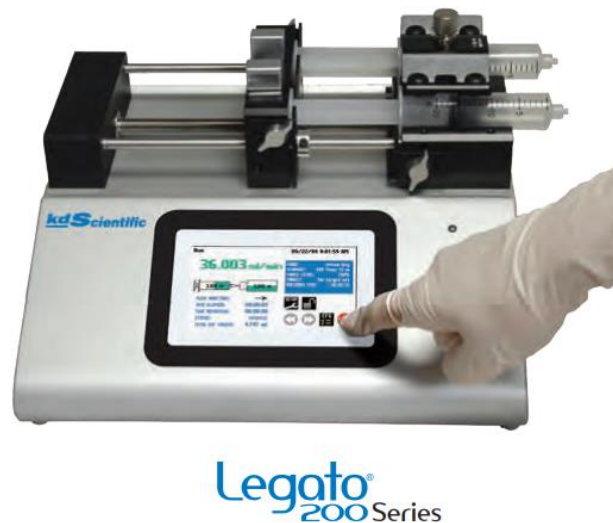
Figura 16: Equipo de bombeo de jeringas Legato 200 series, fuente kdScientific
