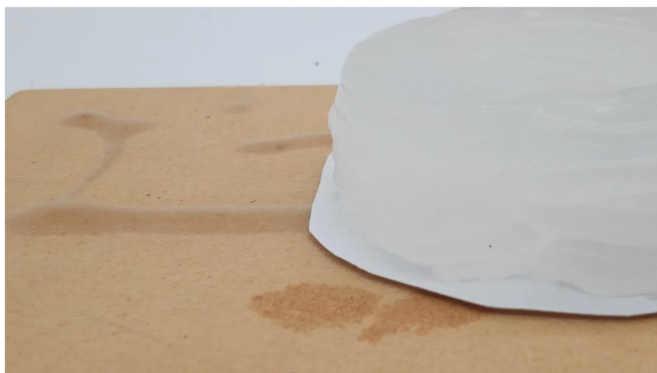
A. 53: Prueba de temperatura en impresión 3D. Almidón 90 [°C acercamiento de capas.]
