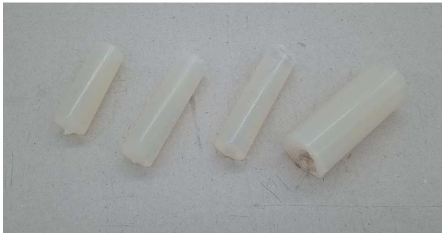
Figura 24: Gelatinización total de bioplástico de agar-agar al ser calentado sobre su temperatura de gelatinización
