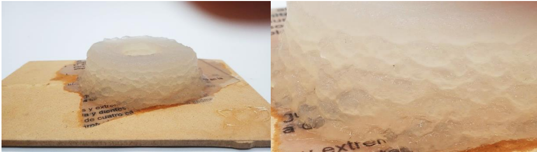
Figura 48: Impresión de bioplástico a base de agar-agar a 60 [°C]
