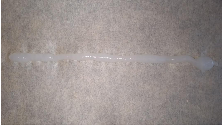
A. 10: Bioplástico después de 1 día dentro de jeringa. Línea 4
