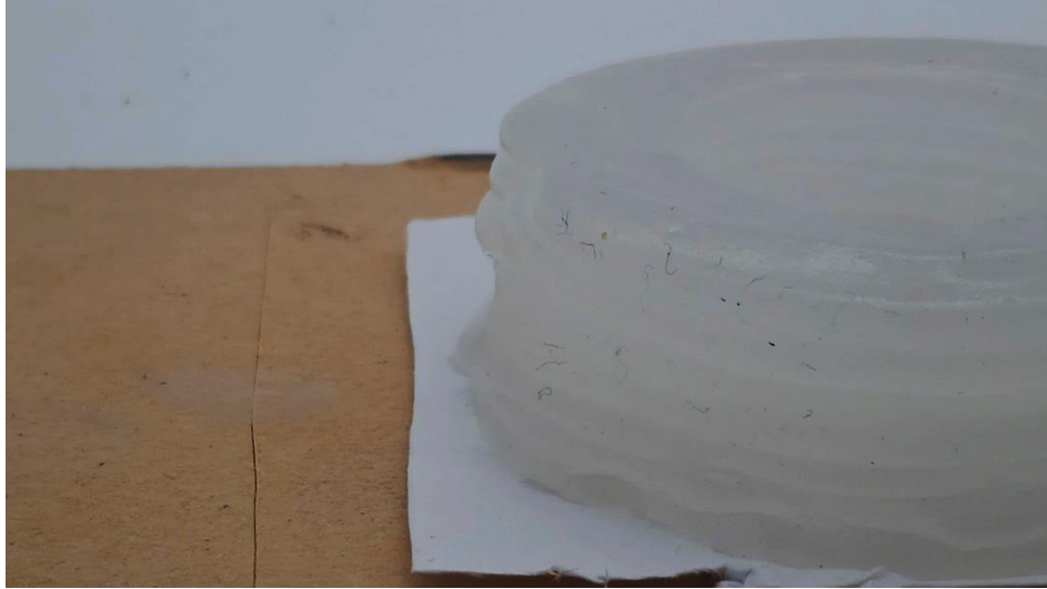
A. 70: Receta ST-W060-0608, 90 [°C] acercamiento de capas.
